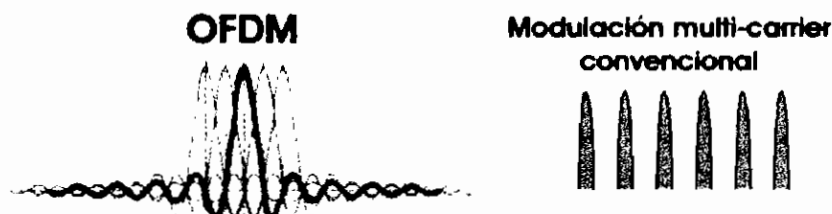
Figura 3.11. Técnicas de modulación: OFDM y multi-portadora convencional
