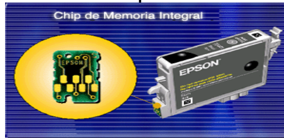
GRÁFICO No 7: Chip de Cartucho de tinta
