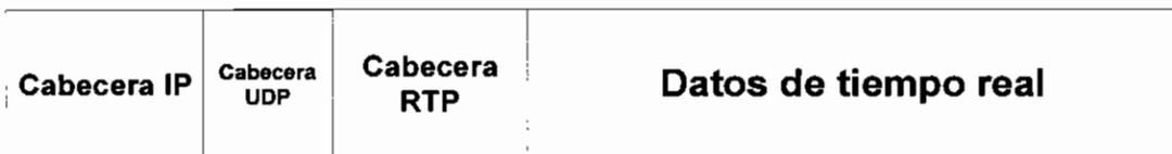
*Figura 3. 10 Paquete IP que contiene datos en tiempo real.*
