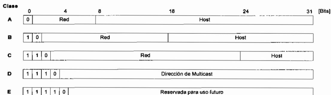
Fig. 1.10. Clases de direcciones IP <sup>[1]</sup>
