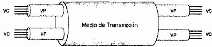
Fig. D.4. Relación entre canal virtual, ruta virtual y medio de transmisión.
