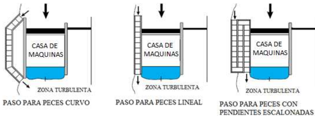
FIGURA 3.20 POSICIONES ESCALA DE DEPÓSITOS SUCESIVOS O ARTESAS (Larinier 1992).
