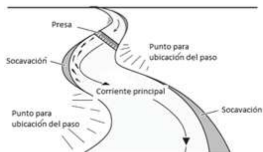
FIGURA 3.3 PUNTOS DE UBICACIÓN DEL DISPOSITIVO DE PASO
