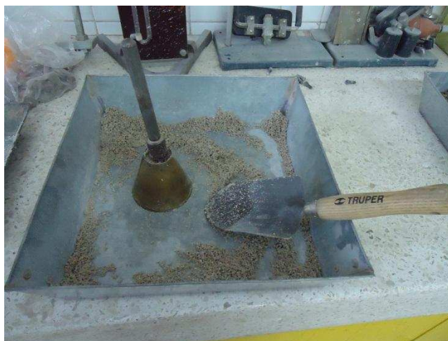
Figura No 2.7 Molde y compactador
