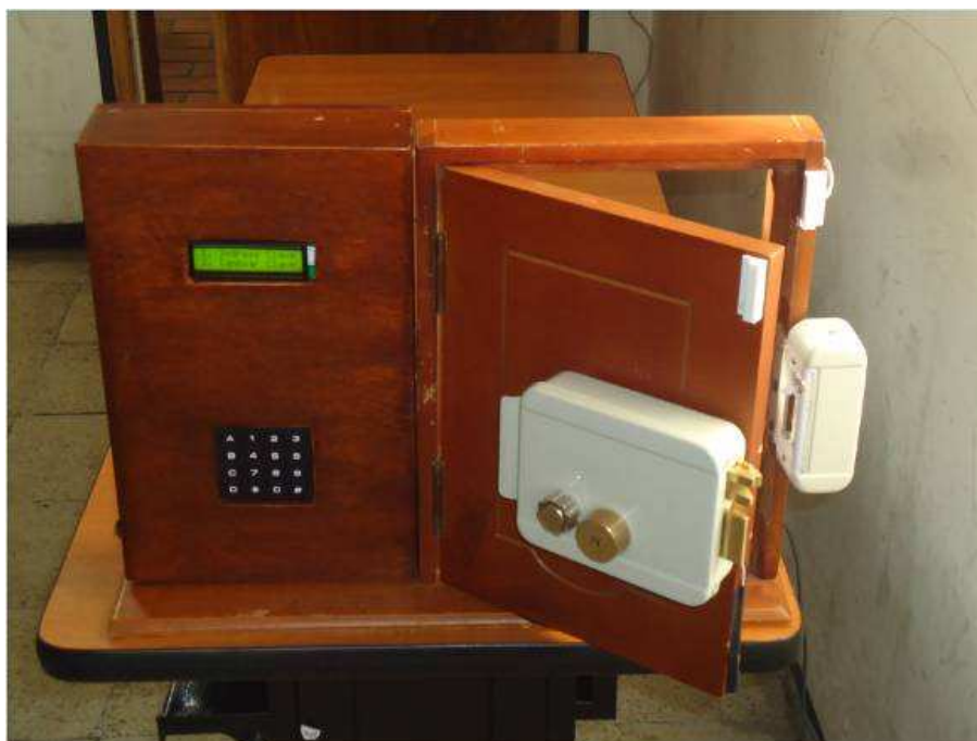
Figura 3.30 Nodo Control de Acceso.
