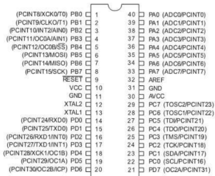
Figura 2.7 Distribución de pines del microcontrolador ATMEGA164p. [26]
