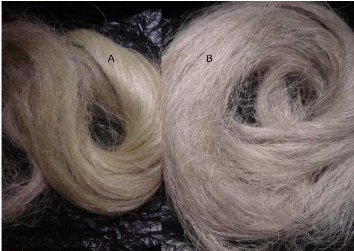
Figura 3.1. Fibras de formio (A) sin descruar, (B) descruadas a las condiciones adecuadas
