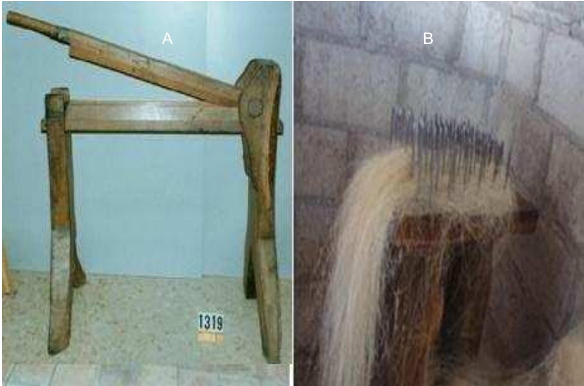
Figura 1.8. (A) agramadora y (B) escarmenadora (Espluga, 2008)
