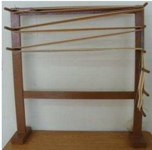
Figura 1.12. Urdidor artesanal en el que se colocan los hilos de urdimbre antes de pasarlos al telar
