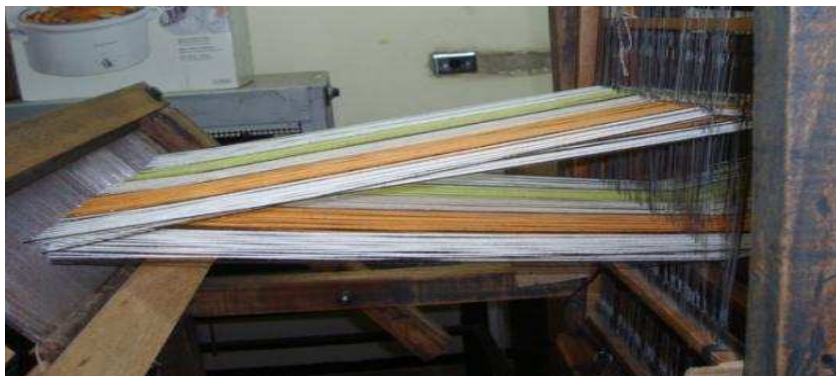
Figura 1.11. Calada formada por los hilos de urdimbre
