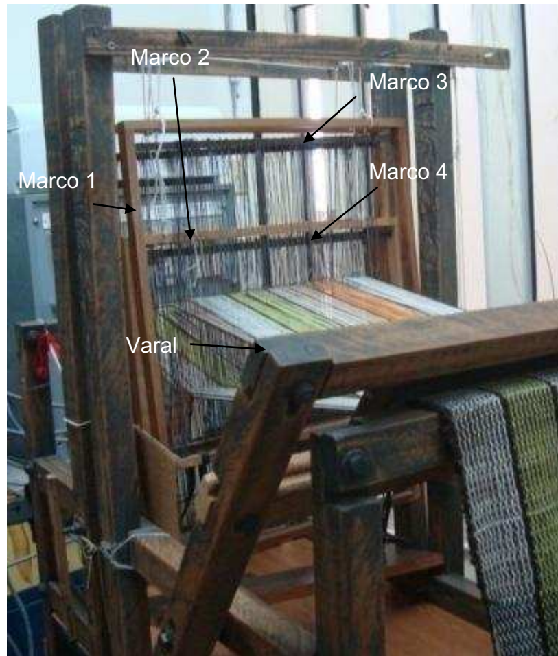
Figura 2.14. Telar manual artesanal usado para elaborar un tejido de ligamento tafetán 1-1
