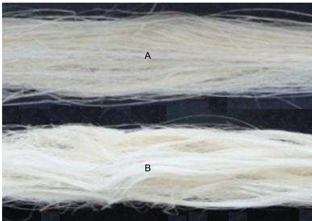
Figura 3.8. Comparación de las fibras de formio (A) descruadas con 2 g/L de NaOH y temperatura de ebullición y (B) descruadas a las condiciones descritas en (A) y blanqueadas con H 2 O 2 50 %, 3 mL/L por 30 min
