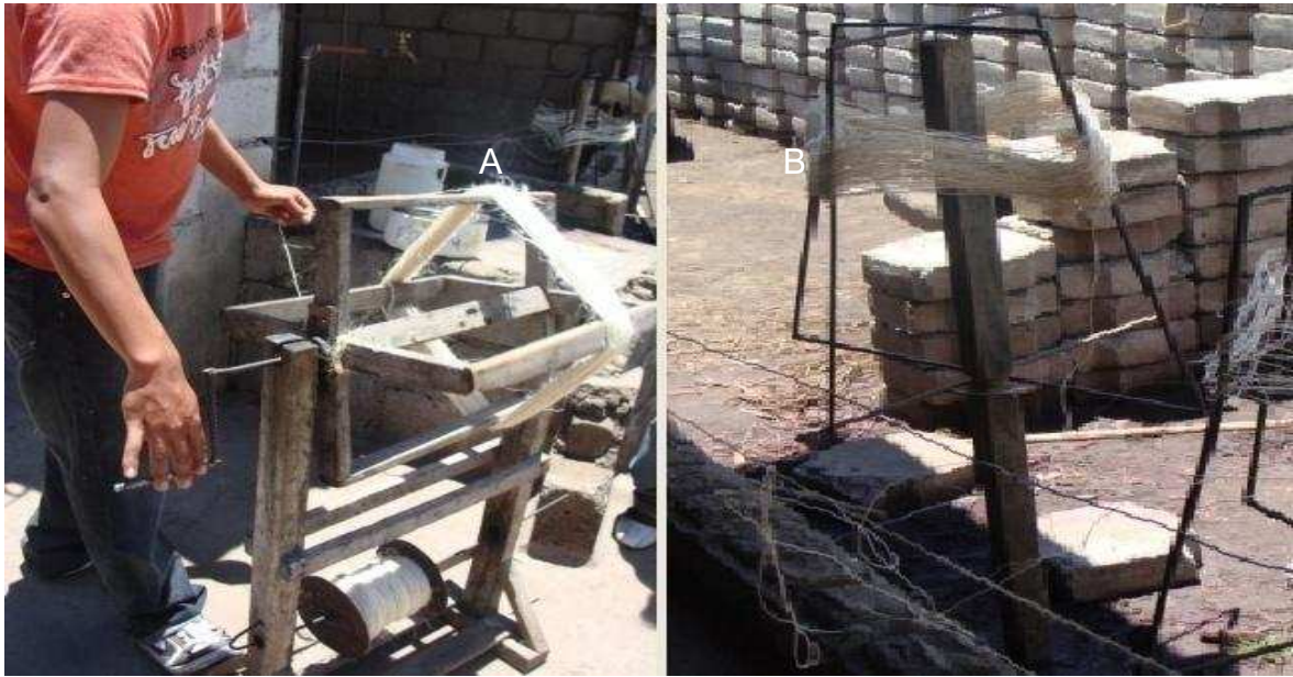
Figura 1.10. Obtención de la madeja de hilo mediante (A) el demore y (B) la devanadera
