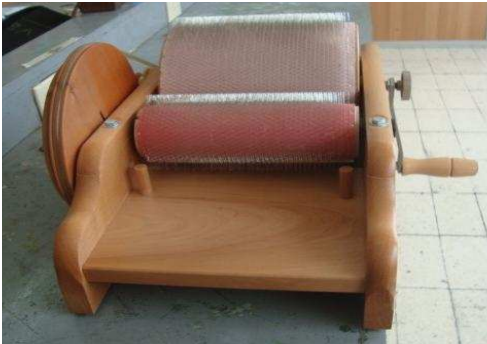
Figura 2.12. Carda mecánica usada en la formación del velo de fibra corta de formio
