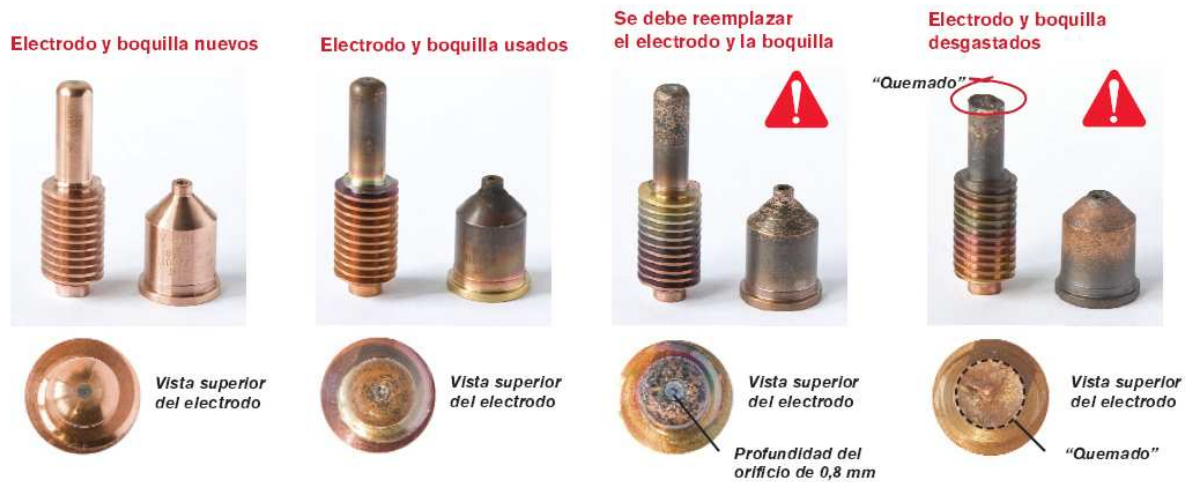
Figura 4.26 Deterioro de los consumibles PAC
