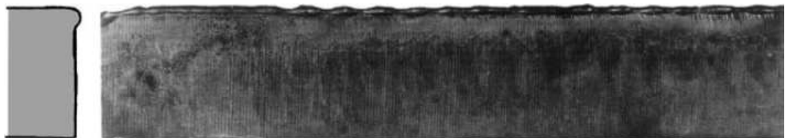
Figura 2.32 Llama de precalentamiento excesiva 61
