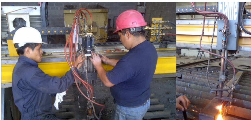
Figura 4.16 Acciones correctivas y puesta en marcha de la antorcha de corte oxiacetilénico
