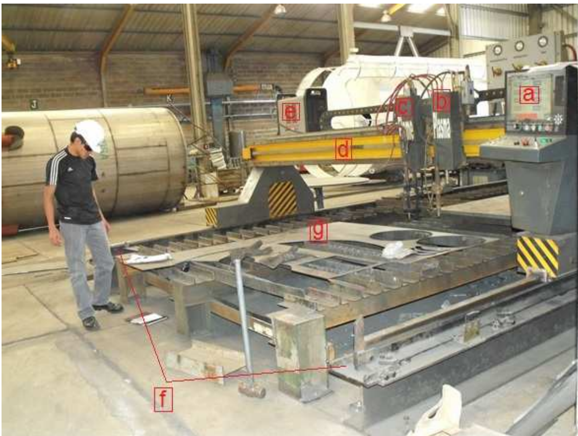
Figura 4.1 Partes que conforman el sistema de corte tipo pórtico; a) Control numérico computacional (CNC); b) Antorcha de plasma; c) Antorcha de oxiacetilénico; d) Pórtico; e) Generador de plasma; f) Bancadas; g) Mesa de corte.
