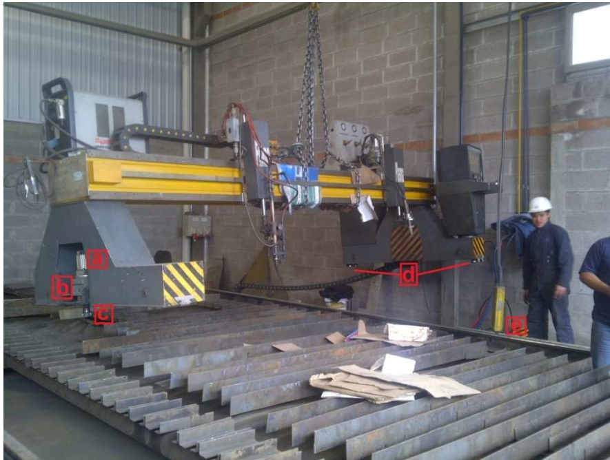
Figura 4.11 Partes de la bancada y el pórtico; a) Servo-motor AC; b) Reductor; c) Engrane de salida; d) Rodamientos; e) Bancada.
