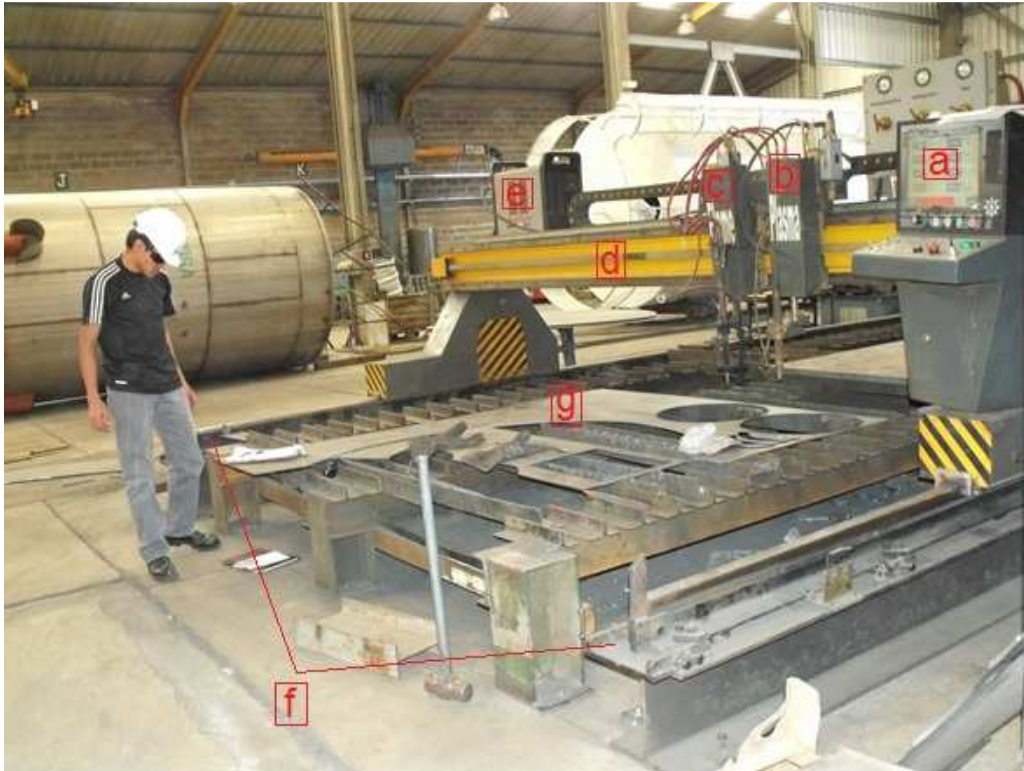
Figura 3.1 CNC – 4000 Flame/Plasma Cutting Equipment; a) Control numérico computacional (CNC); b) Antorcha de plasma; c) Antorcha de oxiacetilénico; d) Pórtico; e) Generador de plasma; f) Bancadas; g) Mesa de corte. 86
