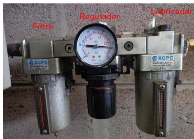
Figura 4.5 Unidad de mantenimiento FRL
