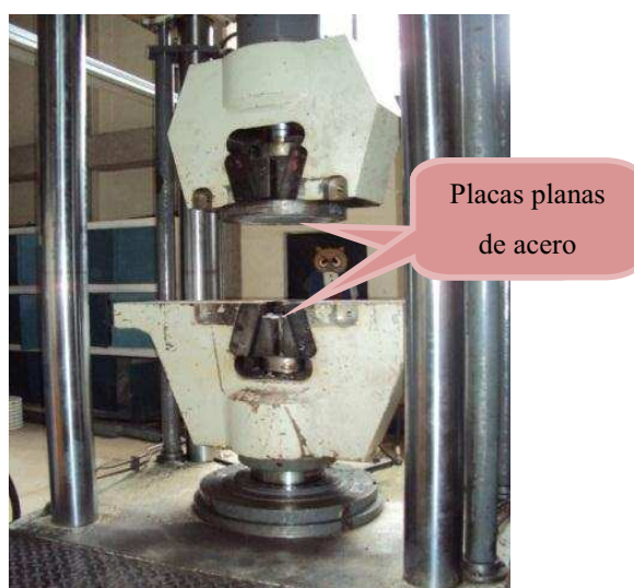
Figura 2.6. Equipo Suz Pecar Servosis utilizado para la compresión de adoquines.
