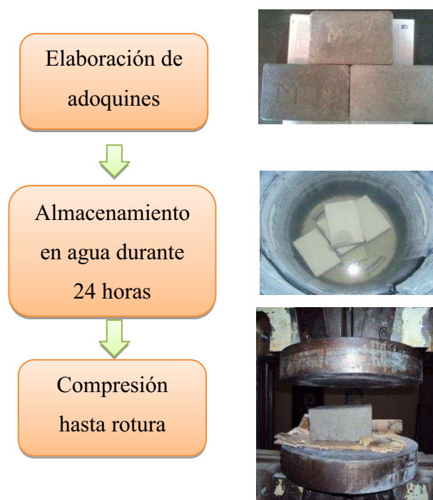
Figura 2.5. Procedimiento para el ensayo de compresión de adoquines.
