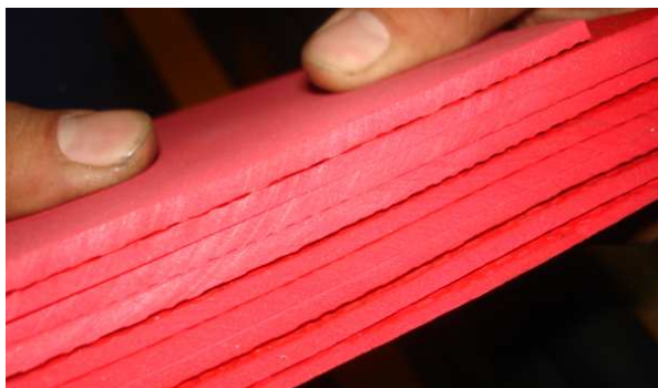
Fig. 2.4 Fomix cortado con el uso de una cortadora de tela.
