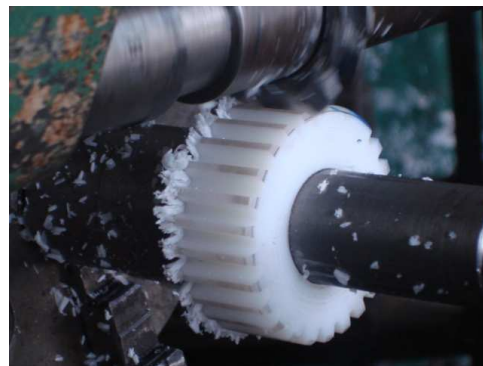
Fig. 3 Construcción de engranes de 60mm con el uso del cabezal divisor
