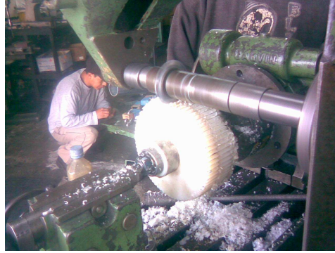
Fig. 4 Construcción de engranes de 150mm con el uso del cabezal divisor
