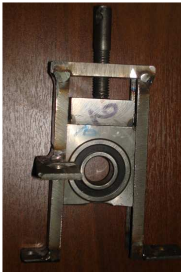
Fig. 5 Construcción de soporte ajustable
