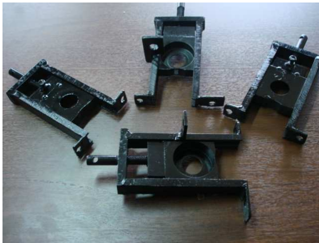
Fig. 6 Construcción de soportes ajustables terminados
