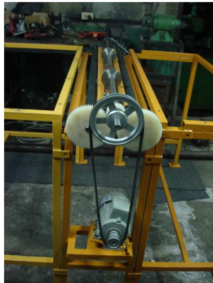
Fig. 9 Montaje de sistema de transmisión de potencia
