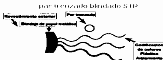
Figura 1.11 Par trenzado STP 16
