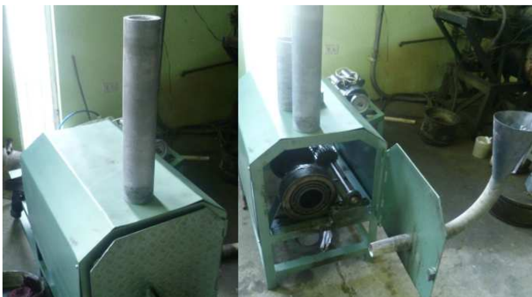
Figura 4.7 Equipo de colado por centrifugado horizontal y el producto obtenido
