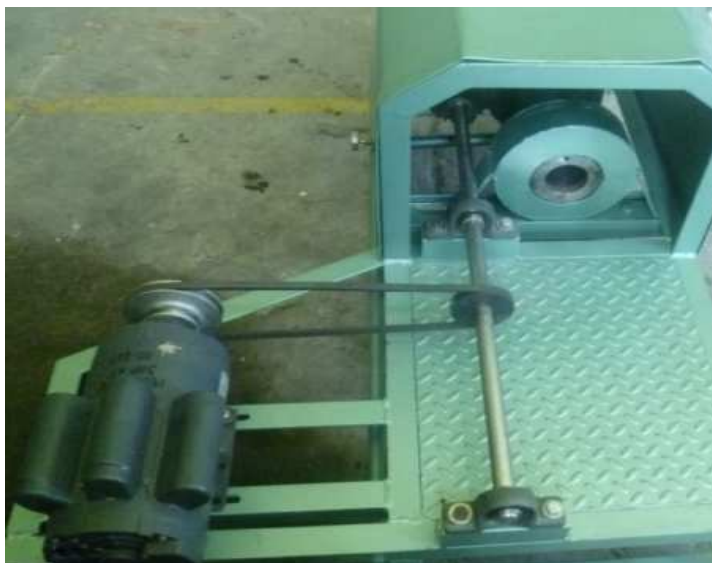
Figura 3.2 Sistema de transmisión en donde se puede observar el motor acoplado a la estructura para transmitir movimiento al molde a través del eje de transmisión
