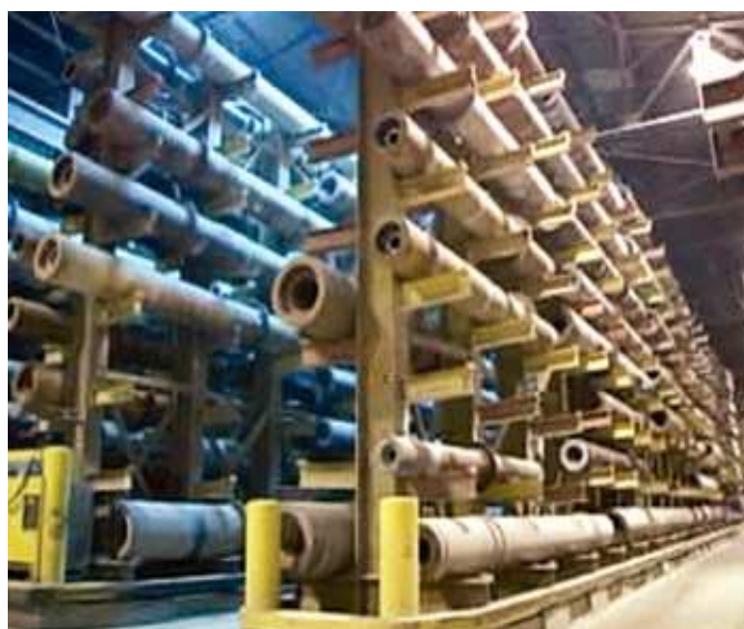
Figura 1.10 Tuberías fabricadas mediante el proceso de colado por centrifugado horizontal en la región rusa.
