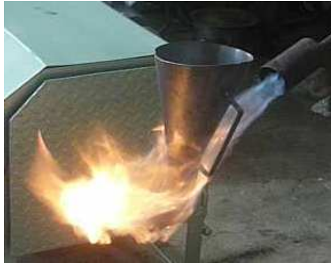
Figura 2.7 Pre calentamiento del alimentador para asegurar un adecuado ingreso del material fundido al equipo de colado
