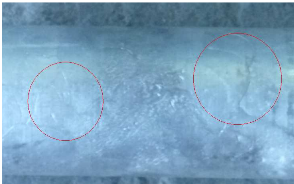
Figura 4.2 Presencia de juntas frías en el primer modelo obtenido
