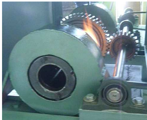
Figura 2.6 Pre calentamiento del molde mediante una llama generada por gas doméstico
