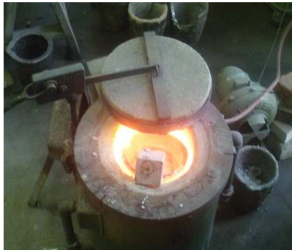
Figura 2.5 Fundición de los lingotes de aluminio hasta una temperatura de 600°C
