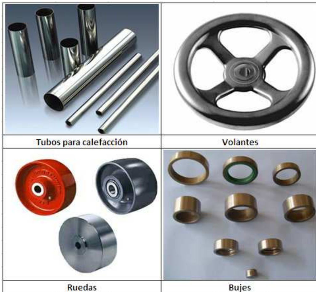
Figura 1.7 Aplicaciones de la fundición por centrifugado
