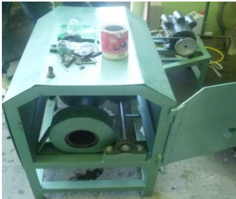
Figura 3.1 Elementos mecánicos solidarios al molde
