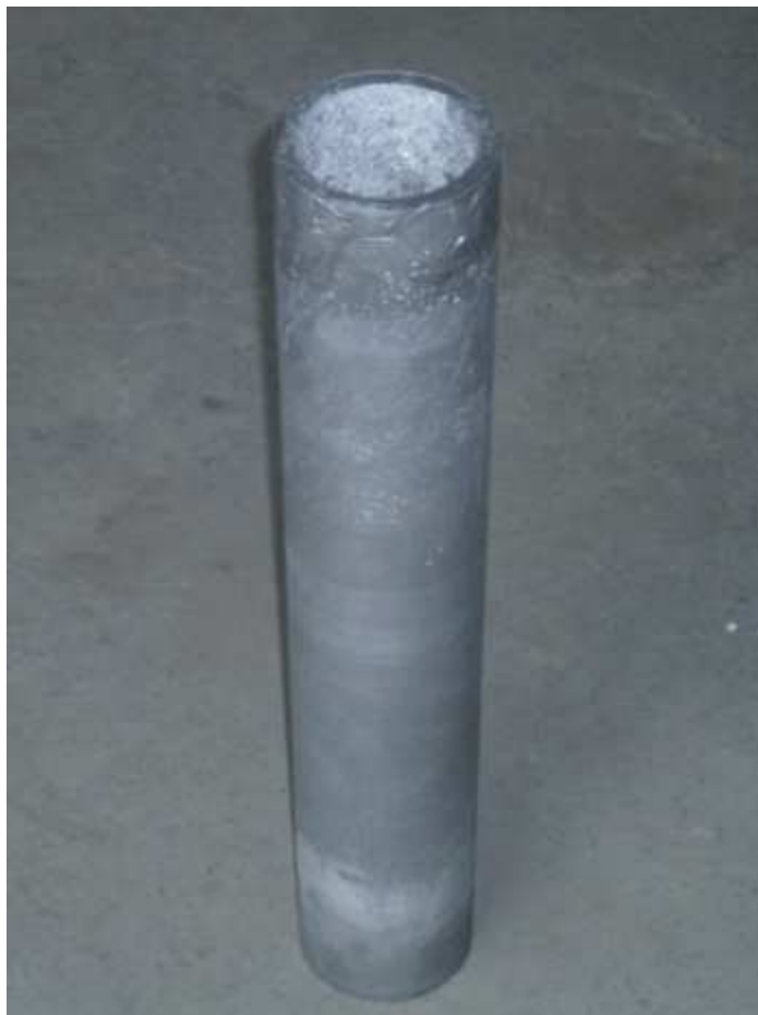
Figura 4.3 Modelo definitivo del tubo sin costura fabricado por el método de colado por centrifugado horizontal.
