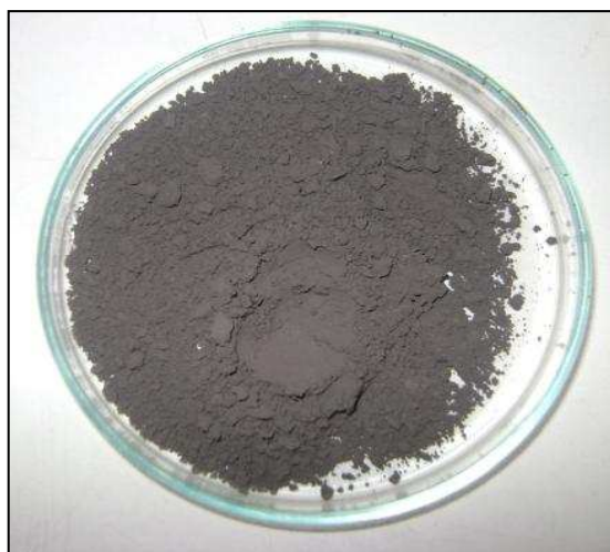
Figura 2.5 Fotografía de una muestra de tarjeta de circuitos impresos pulverizada
