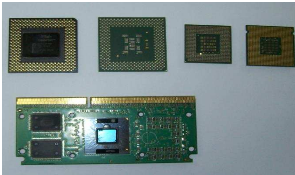
Figura 3.12 Imagen de procesadores usados en los ensayos de cianuración directa agitada y en columna
