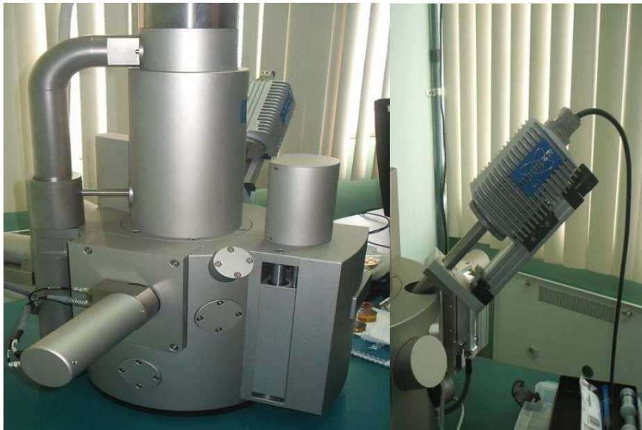
Figura 2.6 Microscopio electrónica de barrido, TESCAN con analizador de rayos x (EDX), empleado en el análisis de elementos
