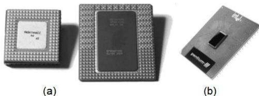
Figura 1.5 Procesadores de sustrato cerámico (a) y sustrato plástico (b) (Mueller, 2012, p. 83)
