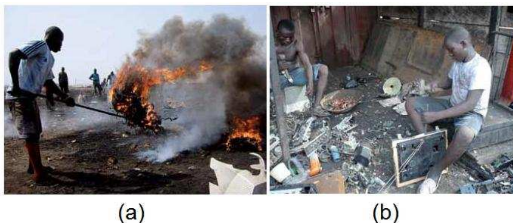
Figura 1.4 Procesos de quema de cables (a) y desensamblaje manual de residuos electrónicos para recuperaciones de metales (Basel Convention, 2011, pp. 25, 29)
