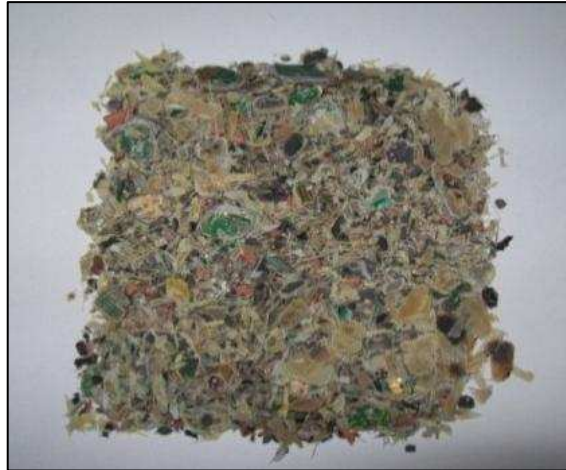
Figura 2.4 Fotografía de procesadores después de la reducción de tamaño en el molino de martillos
