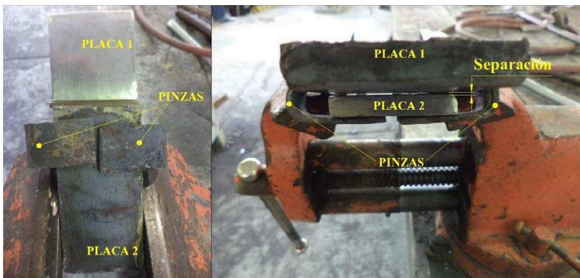
**Figura 6.4.** Ilustración de las pinzas y montaje de las placas.
