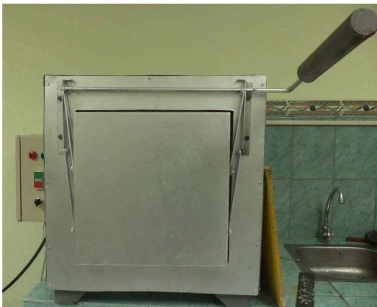
**Fotografía 33.** Horno de tratamiento postsoldadura.
