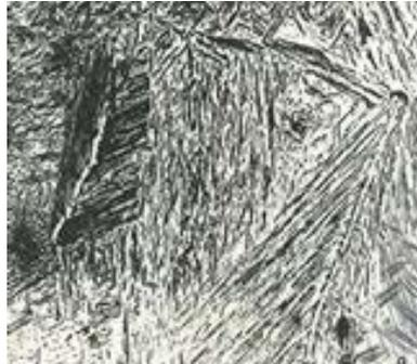
**Figura 1.12.** Microestructura de la martensita.
