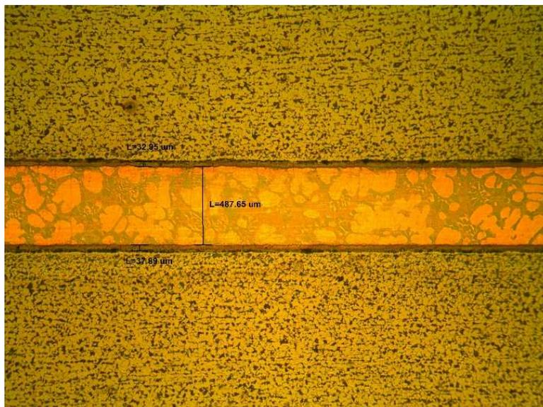
**Fotografía 6.** Unión soldada, amplificación 100x.
