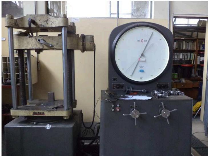
**Figura 6.7.** *Máquina universal de ensayos.*
