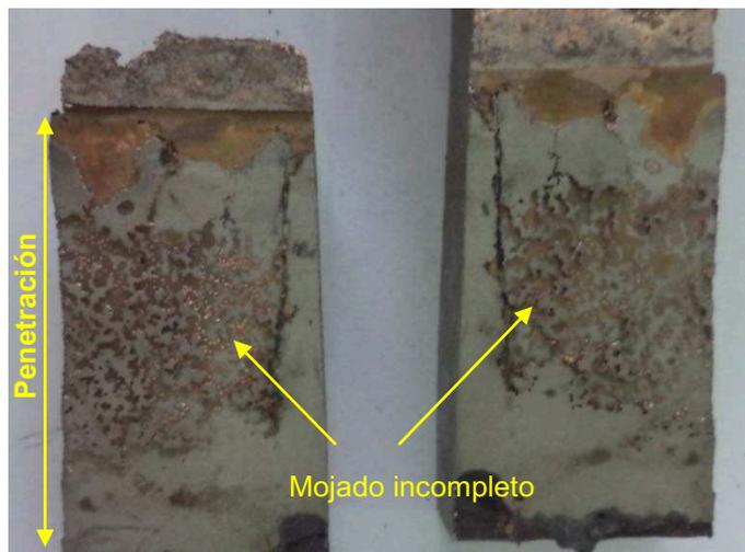
**Figura 7.5.** Mojado irregular del metal de aporte en la probeta A36-P.
