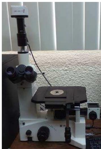
**Figura 6.12.** Microscopio metalográfico.
