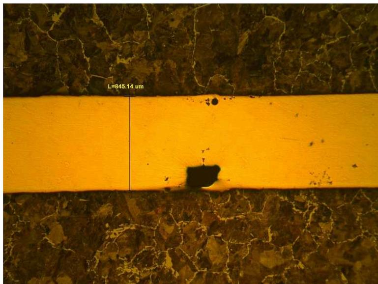
**Fotografía 11.** Unión soldada, amplificación 100x.
