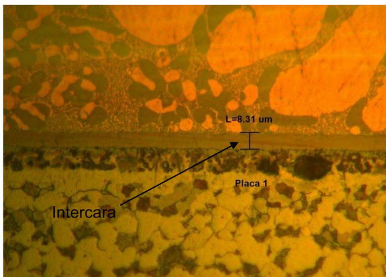
**Figura 7.12.** Metalografía 500x, metal base acero A36 con material de aporte BCuP-3.
