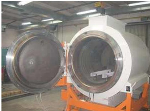
**Figura 4.7.** Horno de retorta 560 - 700 ° C.
