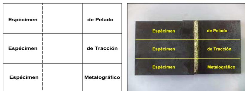
**Figura 7.1.** Junta soldada para calificación de procedimiento.
