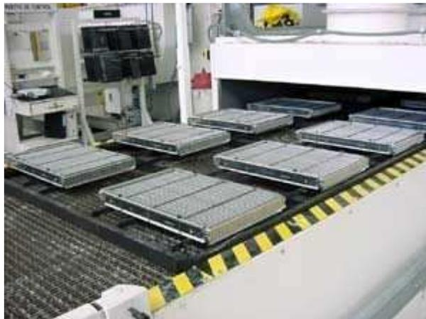
**Figura 4.6.** Horno de soldadura con cinta transportadora CuproBraze®
