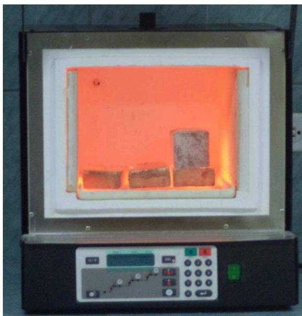
**Fotografía 32.** Colocación de los tabiques refractarios en la cámara del horno.
