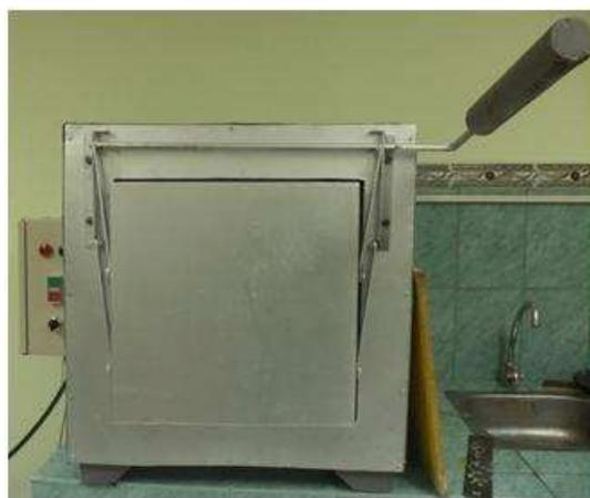
**Figura 6.3.** Horno de postcalentamiento del Laboratorio de Tratamientos Térmicos.
