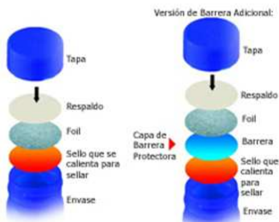
Fig. 1.1: Sello De Una Sola Capa, frecuentemente utilizada en la industria alimenticia
