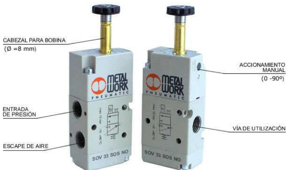
Fig. 1.54: Válvula Distribuidora 3/2 De Mando Electromagnético
