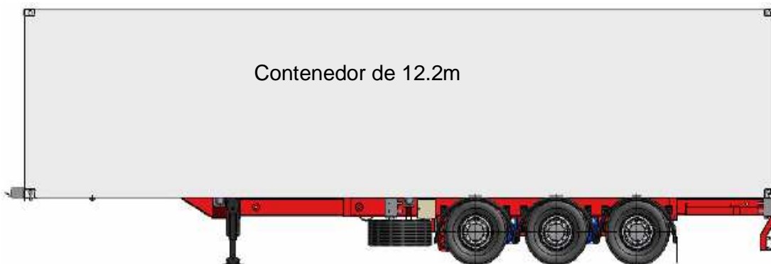
Figura 4-4: Semiremolque adaptado para transportar un contenedor de 12,2[m] o dos contenedores de 6,1[m].
