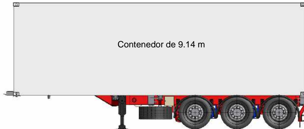
Figura 4-3: Semiremolque adaptado para transportar un contenedor de 9.14m.
