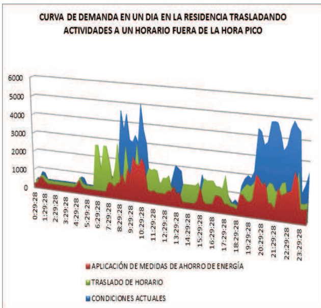
Figura 22. Curva de demanda en un día en la residencia si se traslada las actividades realizadas en la hora pico a otro horario.
