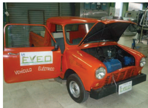
Figura 17. Vista del montaje del motor eléctrico.
