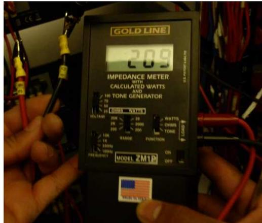
Figura 4.6 Medición en terminales que se conectan a la salida del amplificador.
