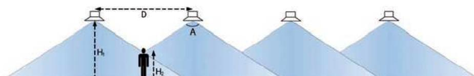
• H1: altura del techo, H2: altura del oído receptor, A: ángulo de dispersión (-6 dB), D: espaciado entre altavoces.
