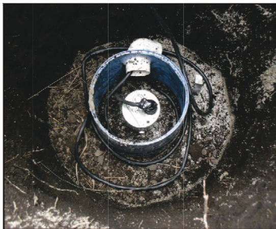
Figura 1.6.- Instalación de un sensor sísmico en una cavidad a una profundidad aproximadamente de un metro.
