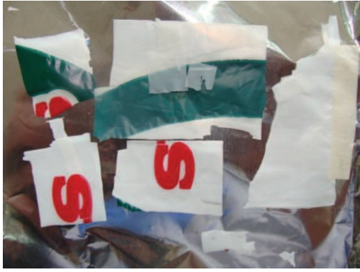
Figura 27. Muestra A1 sometida a degradación térmica durante 600 Horas a 63 °C.
