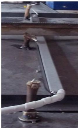
Fig. 4.6 Disposición de termocuplas con aislante térmico.
