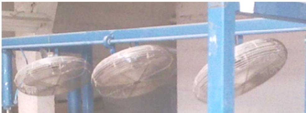
Fig. 1.20 Foto del sistema de enfriamiento de la máquina termoformadora.
