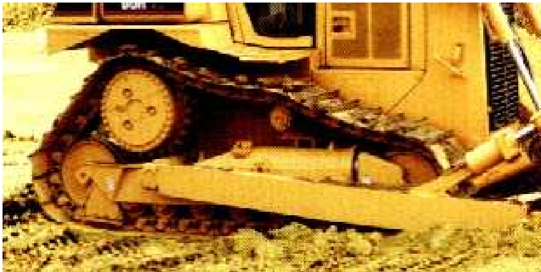
Figura 5.11 Tren de rodaje de Rueda Motriz Elevada.
