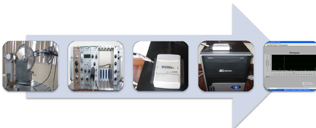
Figura 2.4 Proceso de transmisión de datos. 1) Los rayos X difractados son registrados por el detector de centelleo 2) La señal de datos pasa al equipo de amplificación 3) La señal amplificada pasa a la tarjeta de adquisición de datos 4) La señal digital pasa a la computadora y son procesados mediante el programa LABVIEW 5) Se obtiene el difractograma.
