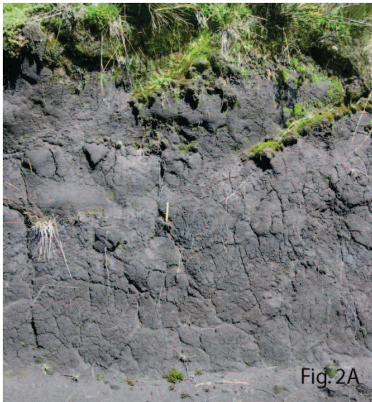
Figura 2: (2A)- Típico perfil de suelo de páramo en la zona de estudio. Consiste de unos 3 m de espesor, homogéneo y masivo, sin estratificación o laminación, y de grano muy fino. (2B)- En sitios afectados por los deslaves el perfil típico consiste de pocos centímetros de suelo, subyacente por una capa dura, impermeable de tillita con cantos o toba volcánica vieja. El tope de la capa consolidada sirvió para mantener altas presiones de poros en el suelo, y fue la superficie de deslizamiento.
