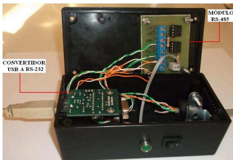
**Figura 3.30:** Módulo de comunicación serial RS232-485 con salida a USB.
