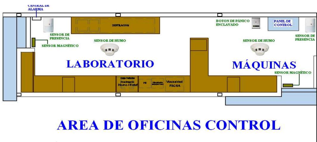
**Figura 2.3:** Esquema de ubicación de los elementos del sistema de alarmas del área oficinas control.
