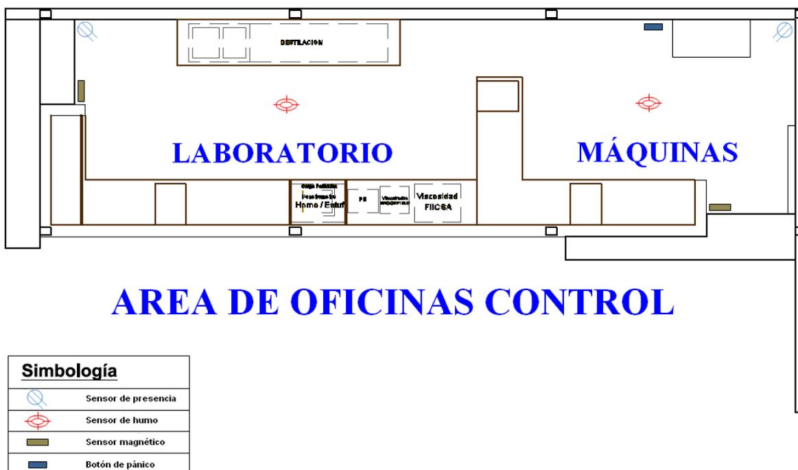
**Figura 1.6:** Plano esquemático de la ubicación de los sensores.
