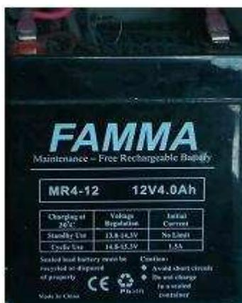
**Figura 2.18:** Batería de respaldo.
