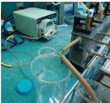
**Figura 2.13** Reactor anaerobio con reciclo
