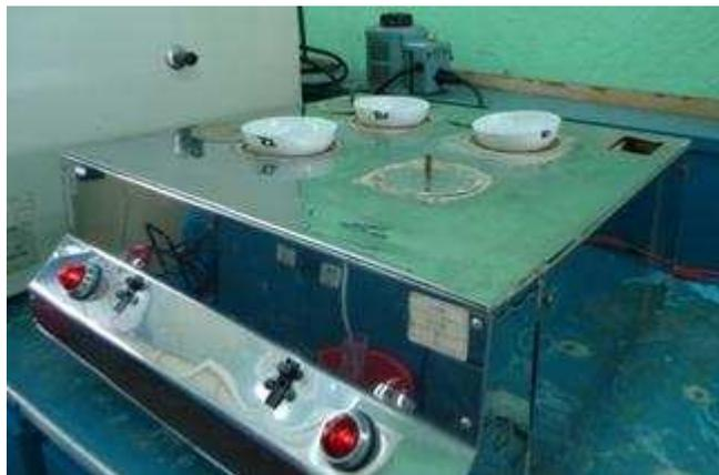
**Figura AIII.4** Baño maría utilizado para la evaporación del agua en la determinación de sólidos
