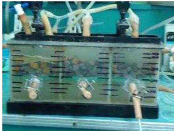
**Figura 2.11** Reactor anaerobio de lecho fijo de flujo ascendente
