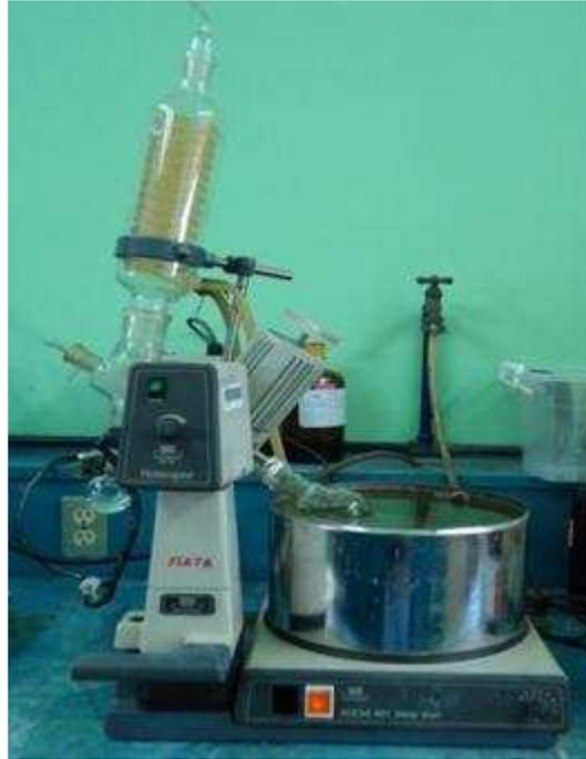
**Figura AIII.3** Rota vapor utilizado para la evaporación del hexano
