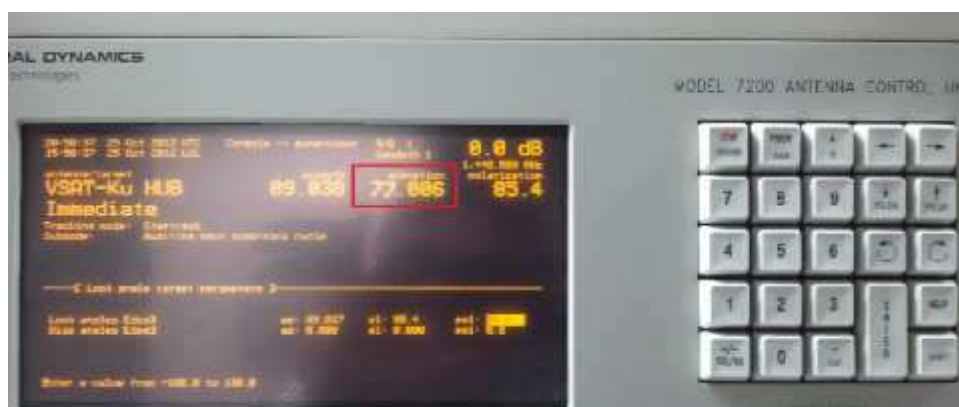
Figura 4. 9 Ángulo de elevación implementado en el HUB
