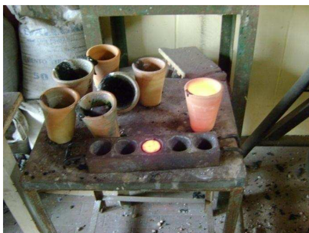
Figura 20. Fusión vertida en la lingotera de acero.
