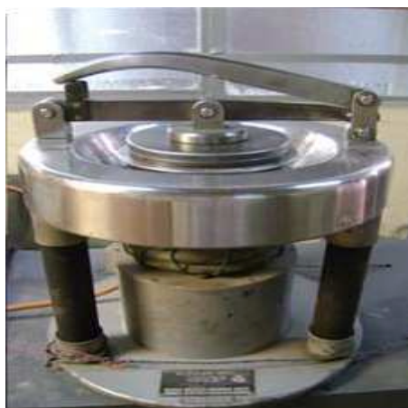
Figura 12. Vista exterior del pulverizador utilizado para la reducción de tamaño.
