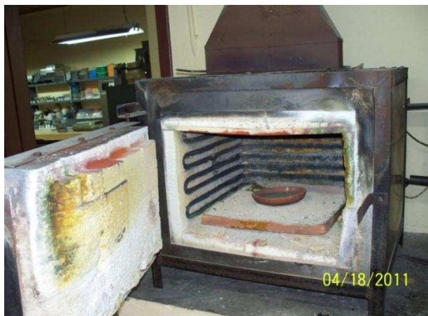
Figura 13. Interior de la mufla SEPOR
