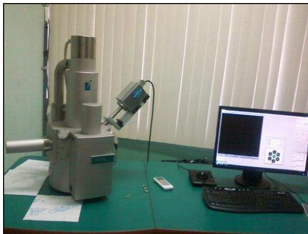
Figura 16. Microscopio electrónica de barrido, TESCAN, empleado en el análisis de elementos
