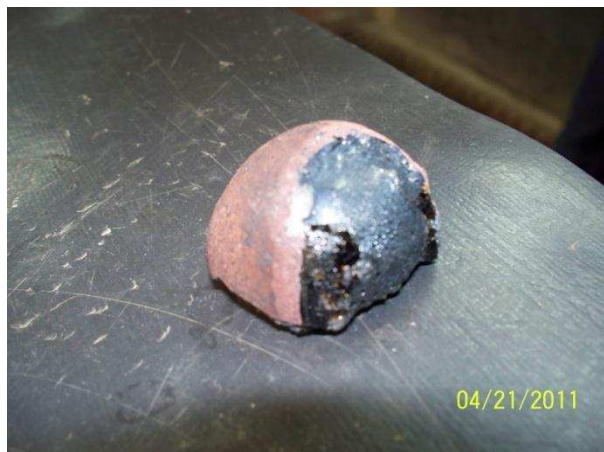
Figura 39. Cobre metálico incrustado en la escoria
