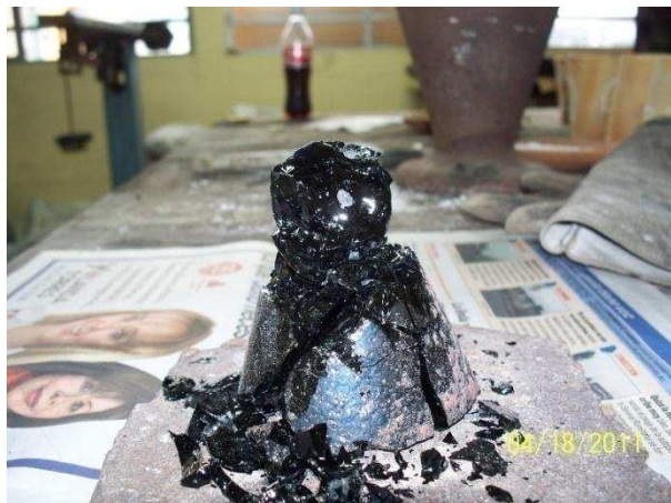
Figura 28. Escoria que recubre una mata de cobre.
