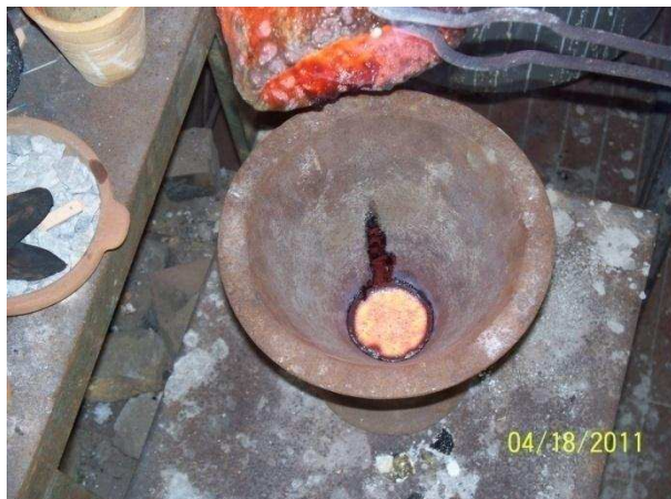
Figura 26. Producto de la fusión reposando en la lingotera de fundición de hierro.
