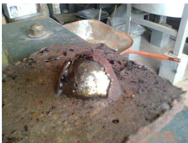
Figura 38. Metal blanco con presencia de Cu incrustado en la escoria
