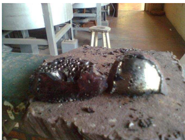
Figura 40. Escoria con presencia de Cu
