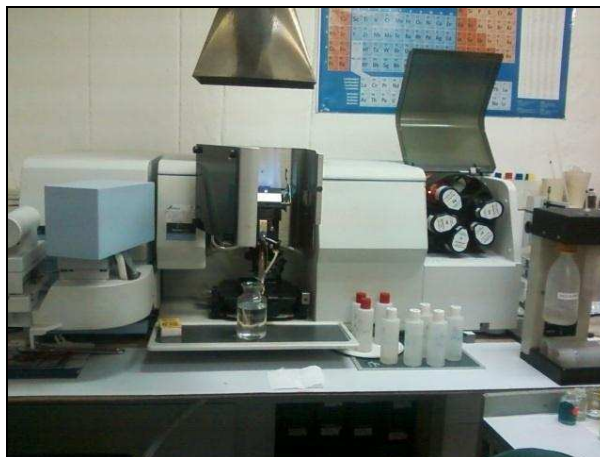
Figura 17. Espectrofotómetro de absorción atómica, AAnalyst 300
