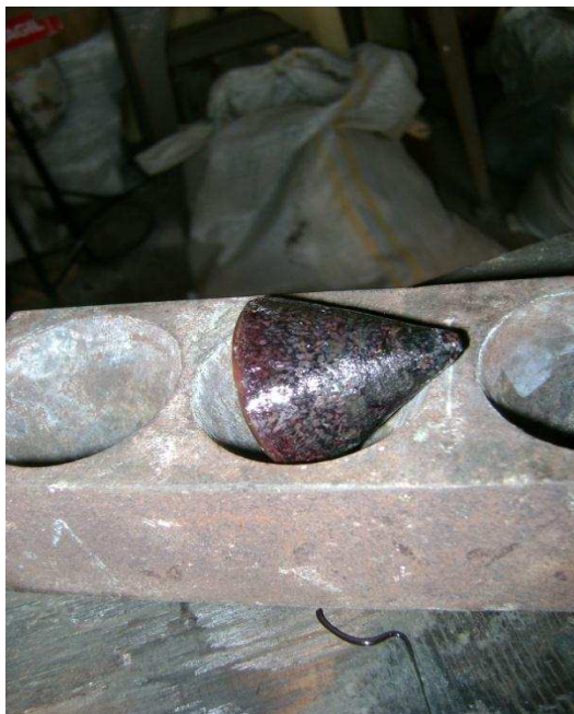
Figura 36. Escoria de color rojizo por presencia excesiva de Cu
