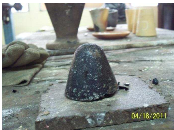
Figura 27. Mata de cobre cubierta de escoria.
