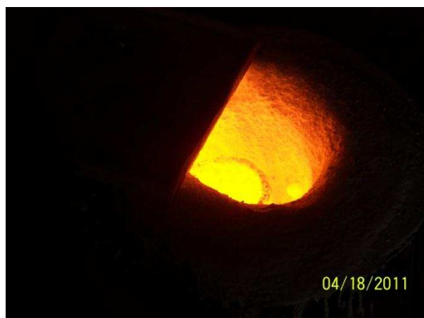
Figura 37. Fusión en crisol de grafito
