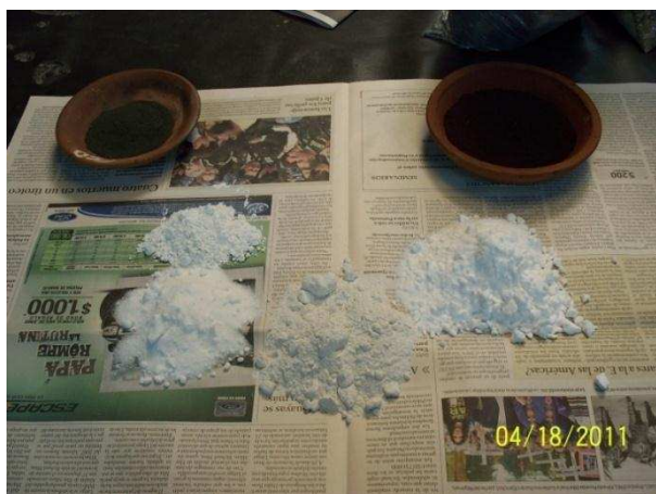
Figura 23. Carga fundente antes de ser homogenizada
