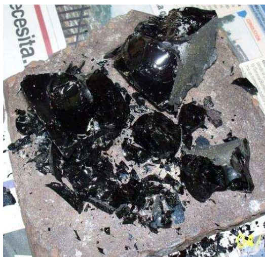
Figura 35. Escoria de fusión por mata sin concentración excesiva de Cu
