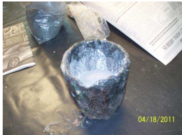
Figura 24. Carga fundente colocada en un crisol de grafito
