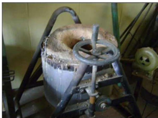
Figura 19. Horno de crisol a gas apagado.
