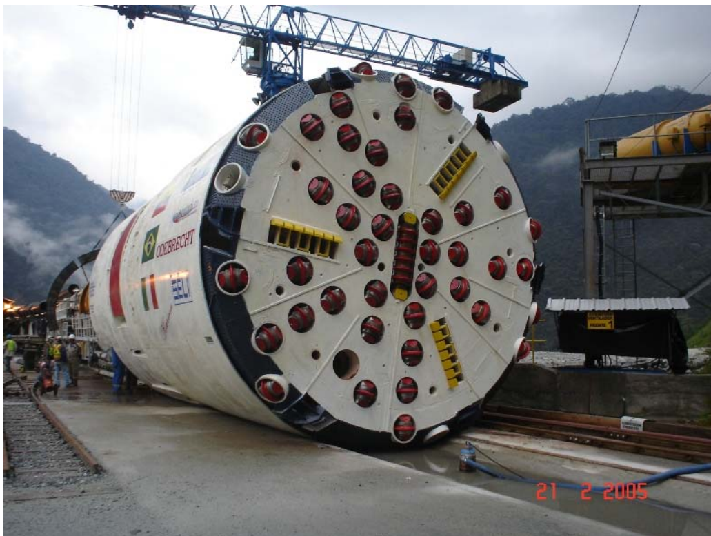
Figura 4.4. Tunnelling Boring Machine utilizada para la construcción del Túnel de Conducción del Proyecto Hidroeléctrico “San Francisco”
