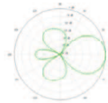
Figura 2. 28 Diagrama de radiación (Polarización Vertical)
