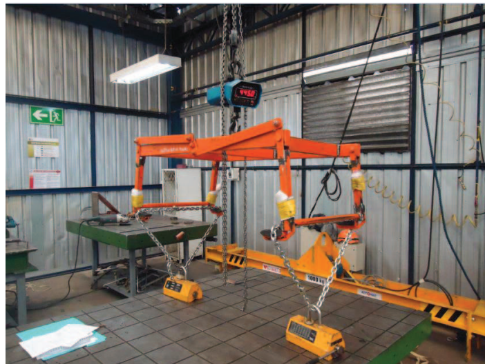
Figura 5.1 Prueba con Carga
