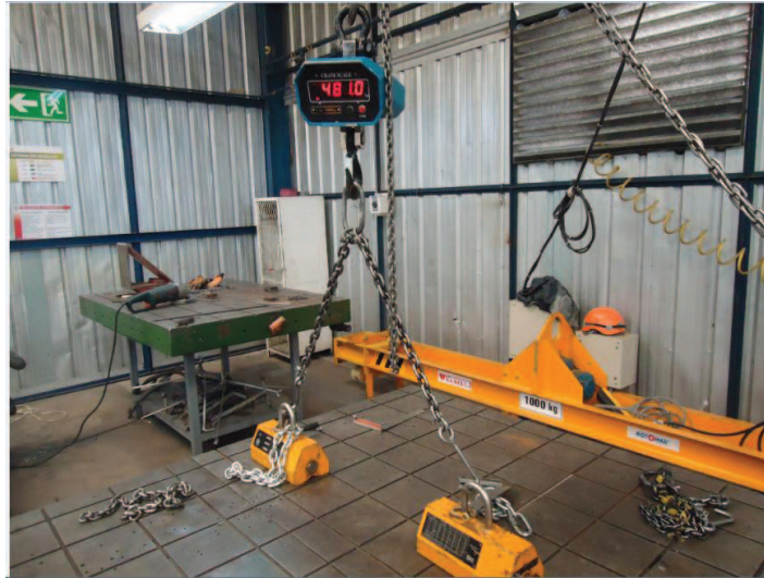
Figura 5. 8 Pruebas con Sobrecarga en Eslinga de Cadena
