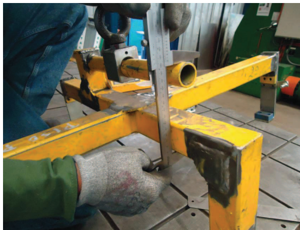
Figura 5.6 Medición de los Dispositivos de Elevación
