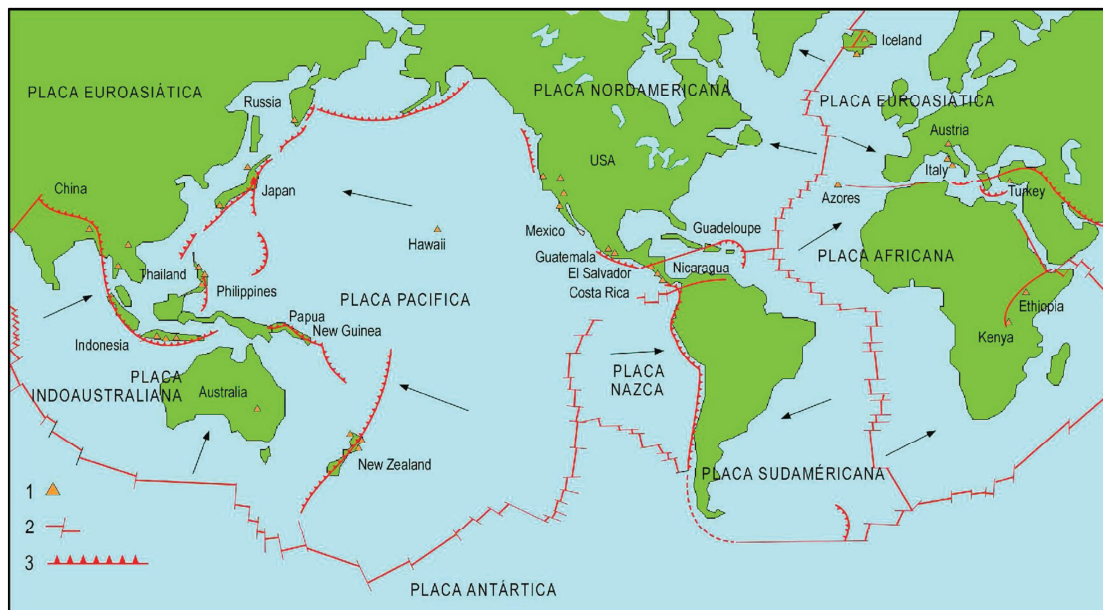
Figura 1. 3. Placas litosféricas, dorsales oceánicas, fosas oceánicas, zonas de subducción y campos geotérmicos.1) Campos geotérmicos que producen electricidad; 2) Dorsales meso-oceánicas cruzadas por fallas transcurrentes 3) Zona de subducción, donde la placa subducida se inclina hacia abajo y se recicla en el manto (Dickson y Fanelli, 2004).
