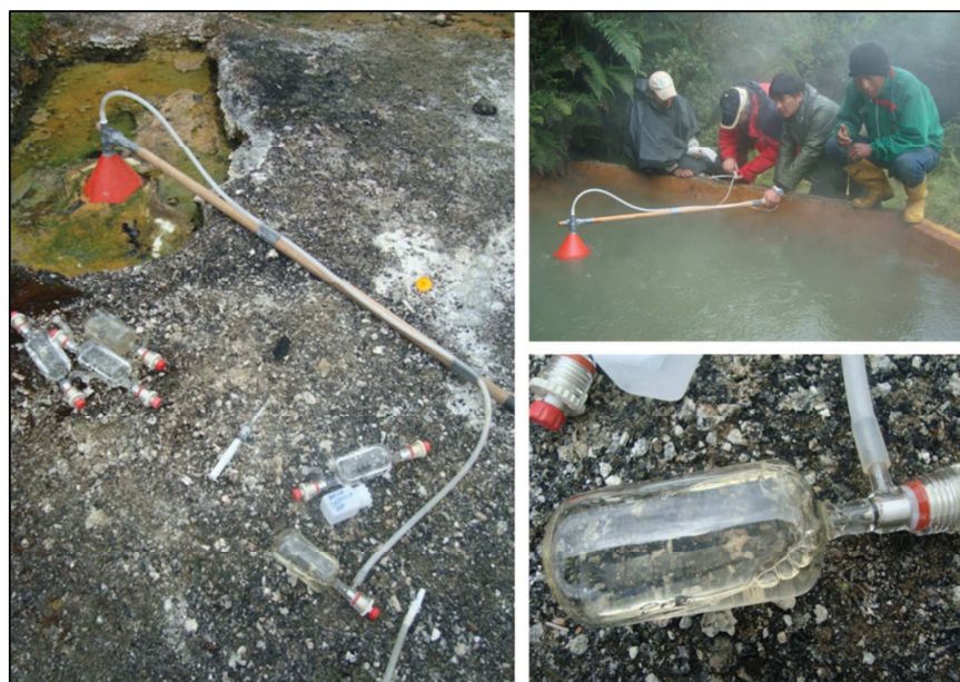
Figura 4. 8. Fotografías tomadas para el muestreo de gas seco. Izquierda. Muestreo de gas en la fuente termal C5. Derecha Superior. Muestreo de gas en la fuente termal T16. Derecha Inferior. Gas que entra al envase Giggenbach con solución de \text{AgNO}_3 en \text{NaOH} .
