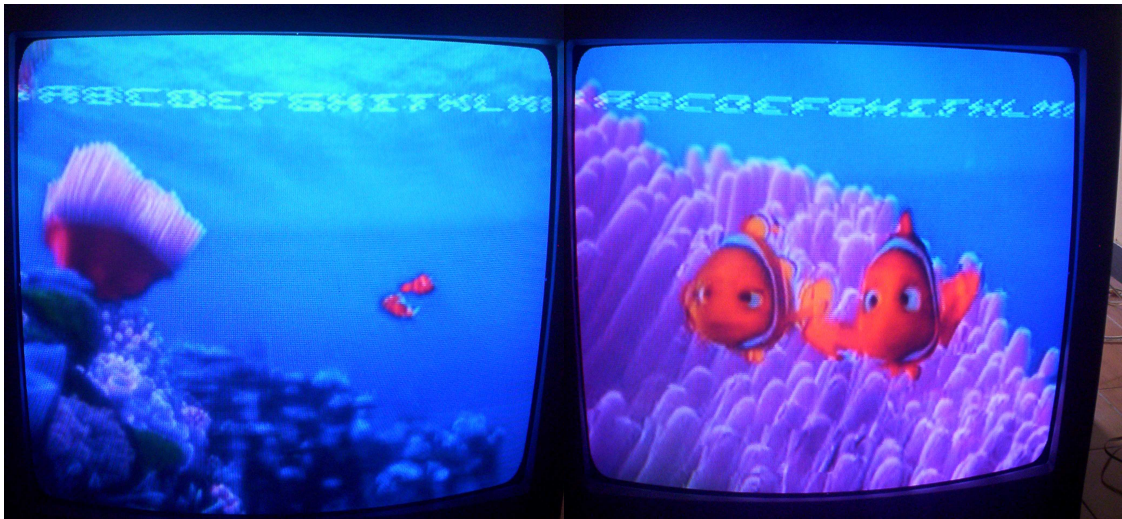
Figura 3.19. Problemas con el sincronismo horizontal
