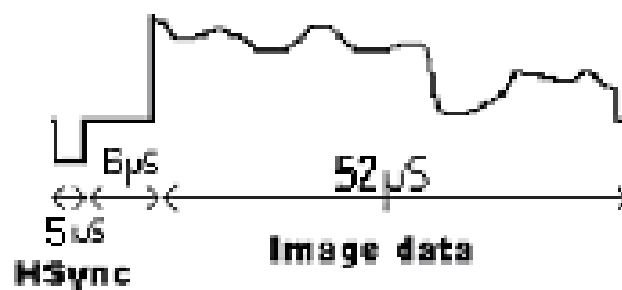
Figura 1.15. Línea que compone un campo
