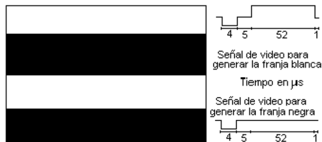
Figura 3.5. Imagen que se intenta lograr por medio del compilador Bascom AVR
