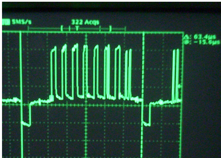
Figura 3.15. Imagen de la señal que genera los caracteres antes mostrados
