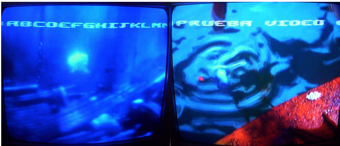
Figura 3.20. Imágenes con los caracteres sobrepuestos en el video
