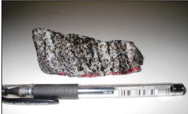
FOTOGRAFÍA 2.16. Muestra de ortogneis (U. Gneis de Sabanilla) recolectada en UTM: 725232-9551995 .Carretera Loja-Zamora
