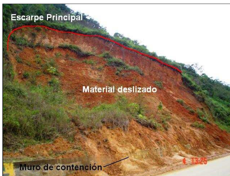
FOTOGRAFÍA 2.19. Deslizamiento Rotacional (Batolito de Zamora; ANEXO 2, LZ 79). UTM: 725327-9551514
