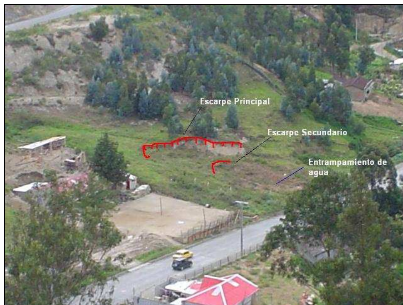
FOTOGRAFIA 2.8. Deslizamiento rotacional activo, Fm. San Cayetano: Miembro Limolita. UTM: 701240-9559471. (LZ3, Ver ANEXO 2)
