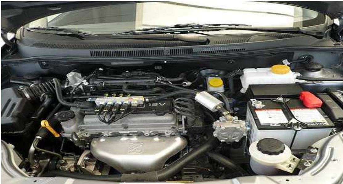
Figura 3.12 Adaptación para un vehículo a GLP 47
