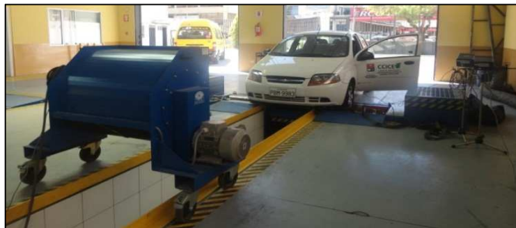
Figura 5.12 Dinamómetro de chasis, correas, ventilador, caja de interfaces.
