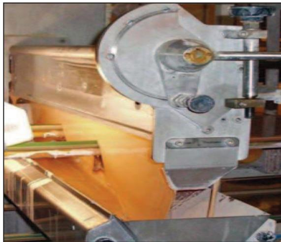
**Figura 1.11.** Esmaltado a cortina mediante sistema vela
