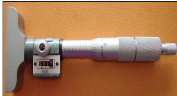
**Figura 2.8.** Micrómetro inglés digital de profundidad, marca CRAFTSMAN
