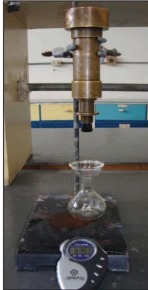
**Figura 2.3.** Fotografía del viscosímetro Saybolt
