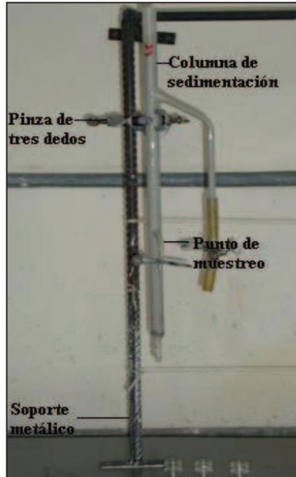
**Figura 2.1.** Fotografía de la columna de sedimentación de vidrio
