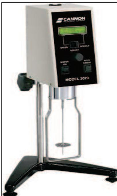
**Figura 2.2.** Viscosímetro digital CANNON
