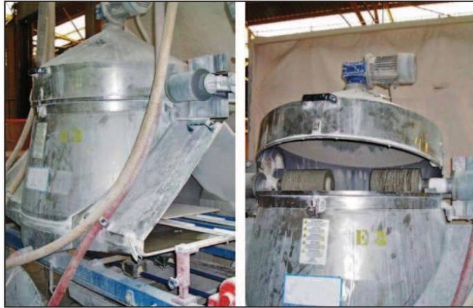
**Figura 1.12.** Esmaltado mediante pulverización a disco
