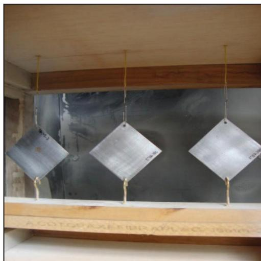
**Figura 2.7.** Fotografía del soporte de madera para esmaltado de placas de 6x6 cm
