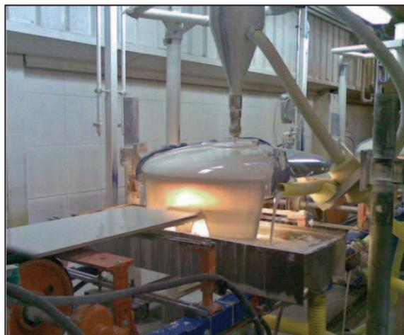
**Figura 1.10.** Esmaltado a cortina mediante sistema campana (ITCCT, 2010, p. 80)
