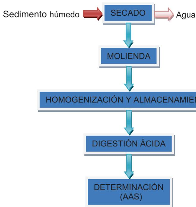
**Figura 2.7.** Esquema de la preparación de muestras y determinación de metales en sedimentos
