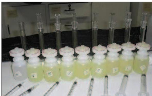
**Figura 2.20.** Equipo de filtrado y soluciones de muestras de peces digeridas
