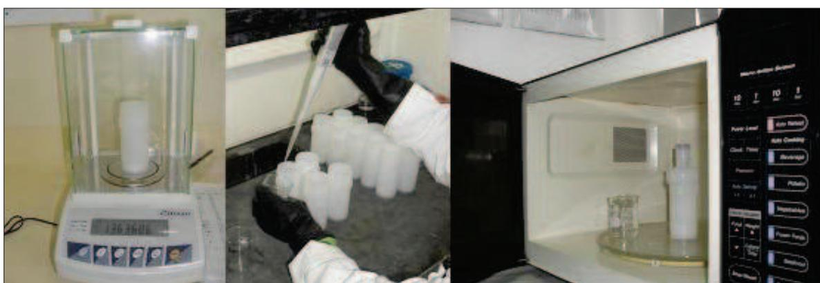
**Figura 2.11.** Pesaje, adición de ácidos y calentamiento de las muestras de sedimentos
