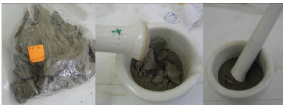
**Figura 2.9.** Molienda de sedimentos hasta apariencia uniforme
