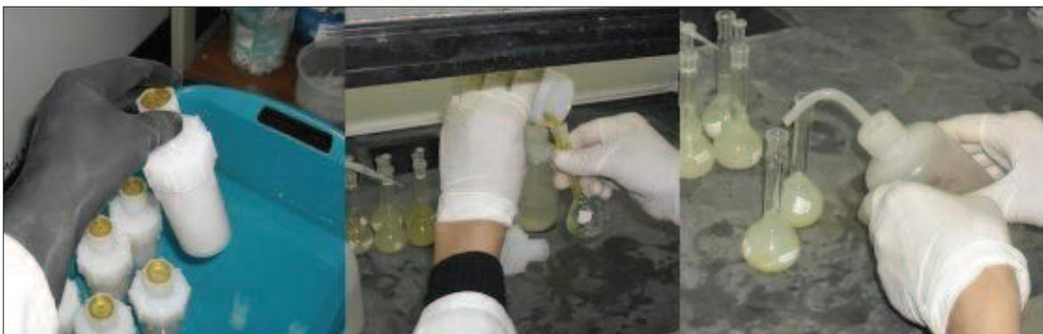
**Figura 2.12.** Enfriamiento, trasvase y aforamiento de muestras digeridas de sedimentos
