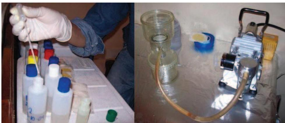
**Figura 2.6.** Acidificación y equipo de filtrado para las muestras de agua
