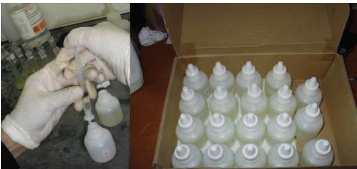
**Figura 2.13.** Filtrado y almacenamiento de las soluciones digeridas de sedimentos
