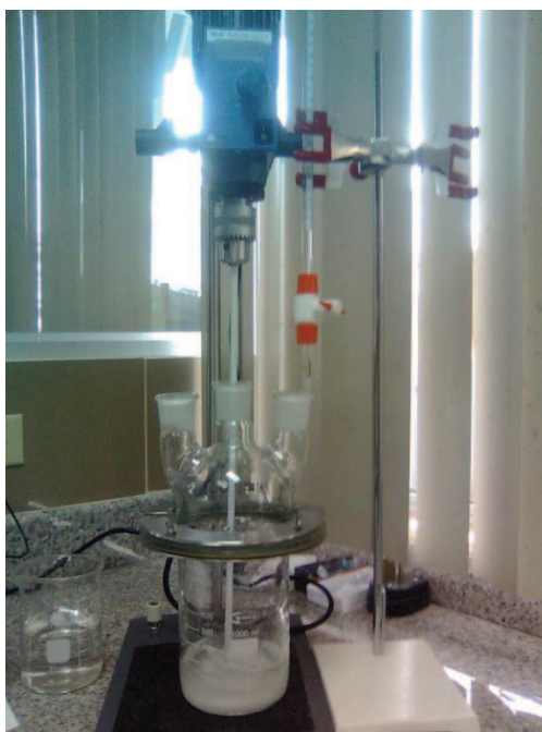
Figura 3.4 —Equipo utilizado en el segundo método de obtención de fosfato de cinc.
