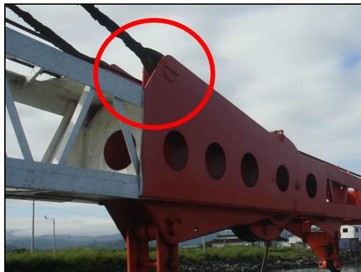
Figura 4.7.- Sujeción de los cables a la pluma.
