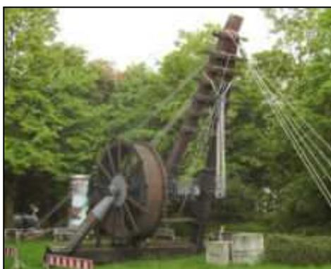
Figura 1.1.- Reconstrucción de un Polispastos romano de 10.4m alto en Bonn, Alemania.<sup>2</sup>
