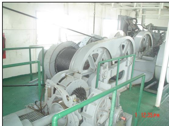
Figura 2.8.- Cuarto de máquinas (Motor combustión interna)
