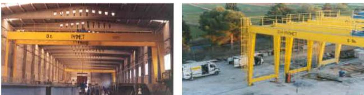
Figura 1.6.- Grúas de pórtico. Industria del acero.<sup>7</sup>
