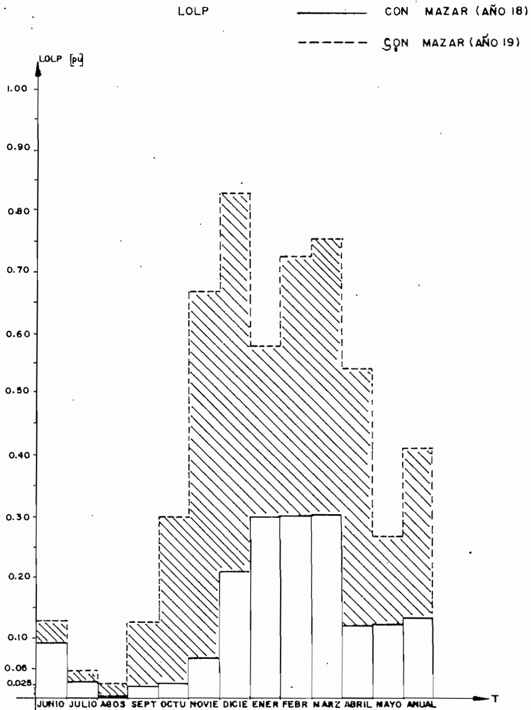
FIG.5.2.c.- LOLP PARA EL SISTEMA EN ESTUDIO , SE COMPARAN DOS POSIBILIDADES. EL AÑO 19 ES UN AÑO DE PRUEBA EN EL QUE SE PROGRAMA IGUAL GENERACION Y DEMANDA MAXIMA MENSUAL DURANTE TODO EL PERIODO. EL AÑO 18 EQUIVALE A LA PROGRAMACION DEL INECEL EN EL AÑO 2002.
