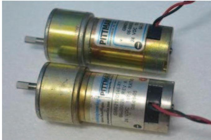
Figura C- 5 Motor DC para la primera articulación
