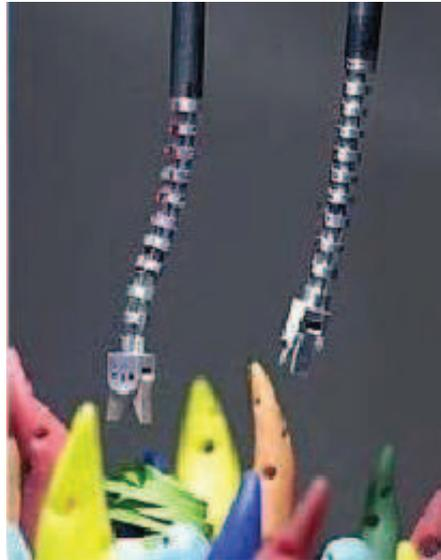
Figura 1.18 Robot manipulador tipo serpiente. [24]
