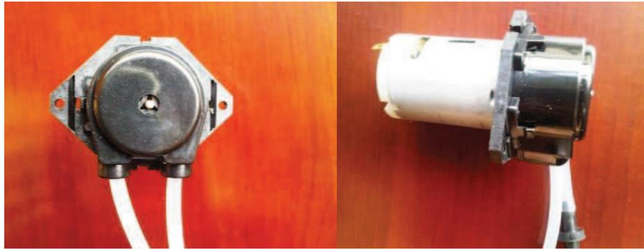
Figura 2.51 Vistas frontal y lateral de la bomba peristáltica utilizada.
