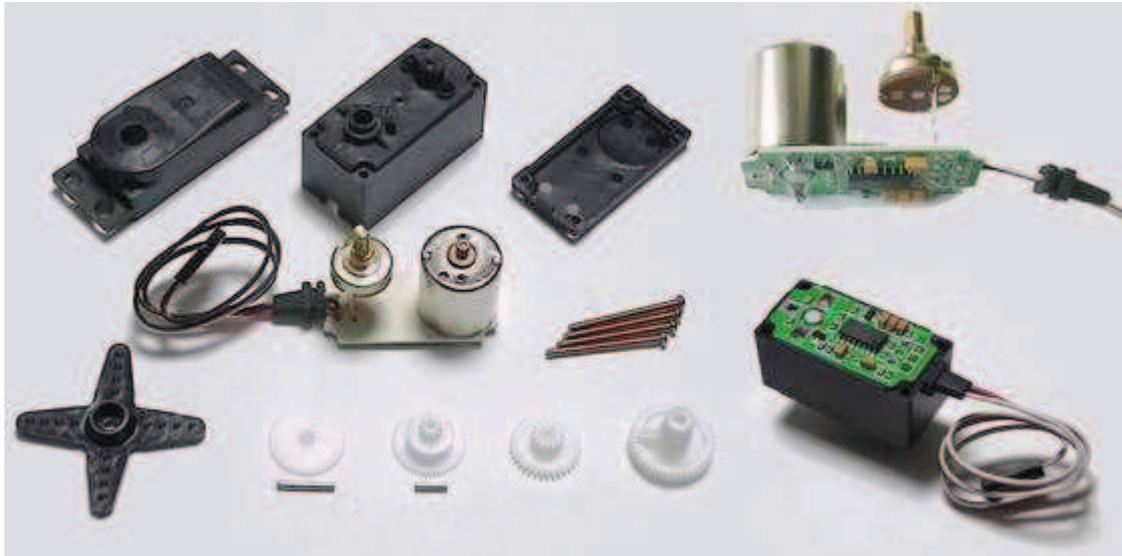
Figura 2.2 Partes que conforman al servomotor [26]
