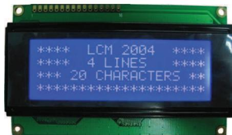
Figura 2.49 Foto de una pantalla LCD 20x4
