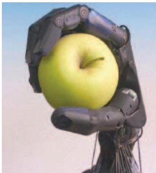
Figura 1.19 Robot manipulador tipo mano. [24]
