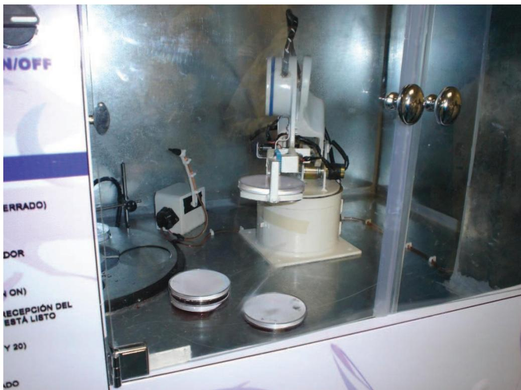
Figura 4.5 Manipulador depositando caja petri llena
