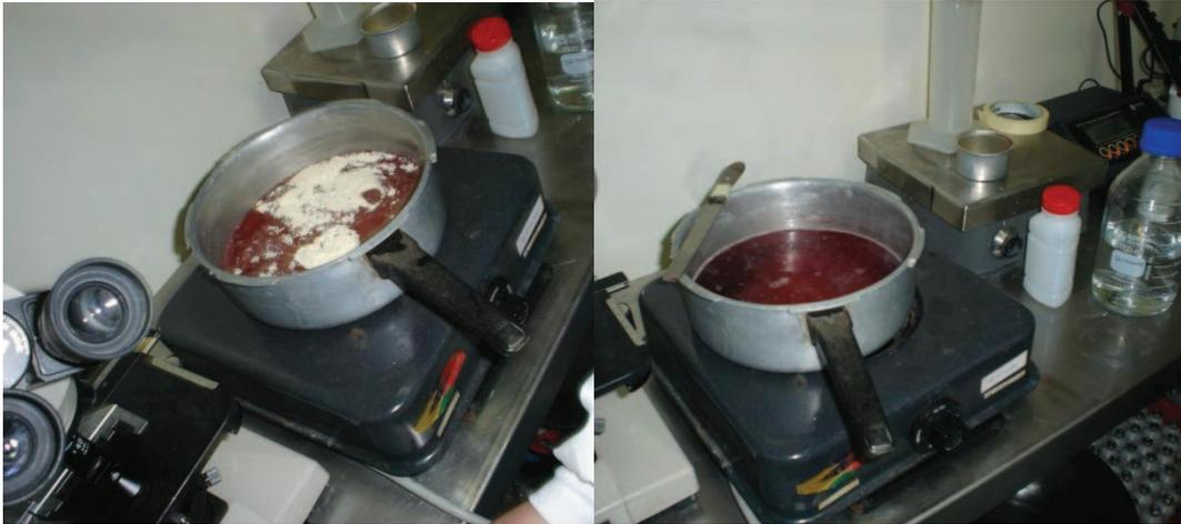
Figura 4.2 Disolución del agar en agua previamente calentada
