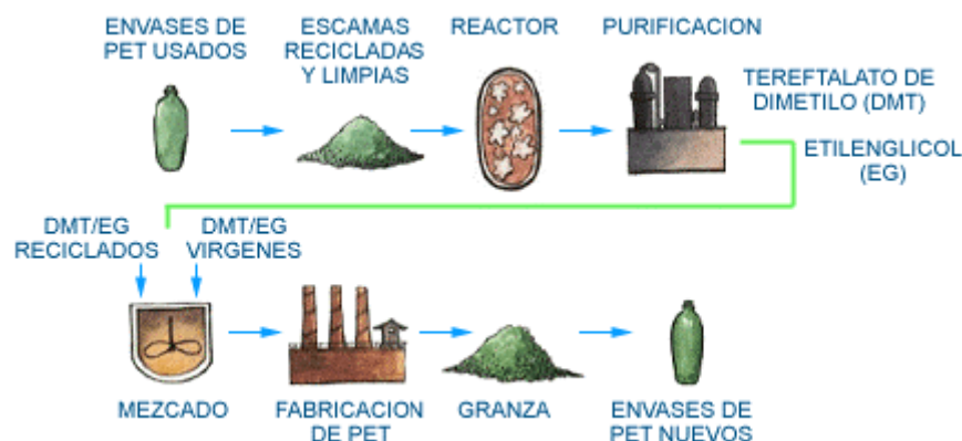
Figura 1. 2 Proceso de Metanólisis (Reciclado Químico)
