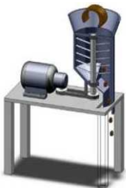
Figura 1. 5 Cortadora rotativa de tipo “picadora de forraje”
