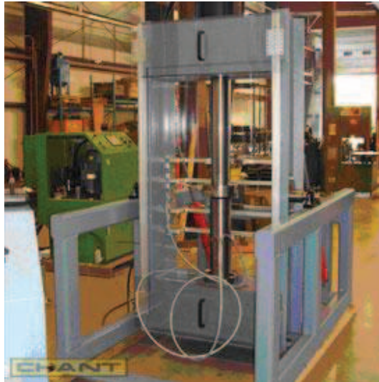
Figura 2.2 Banco de pruebas hidrostáticas Modelo 9727 de Chant Engineering
