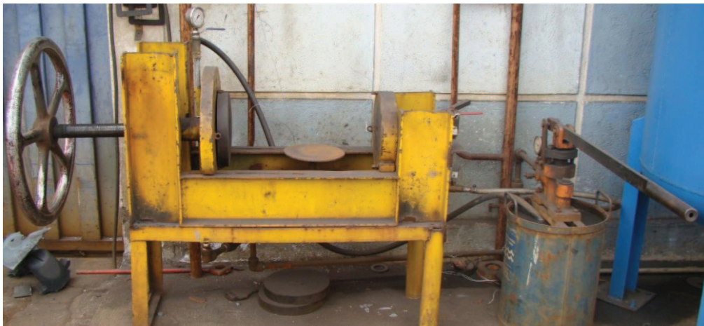
Figura 2.1 Banco de pruebas hidrostáticas de FUNDIRECICLAR
