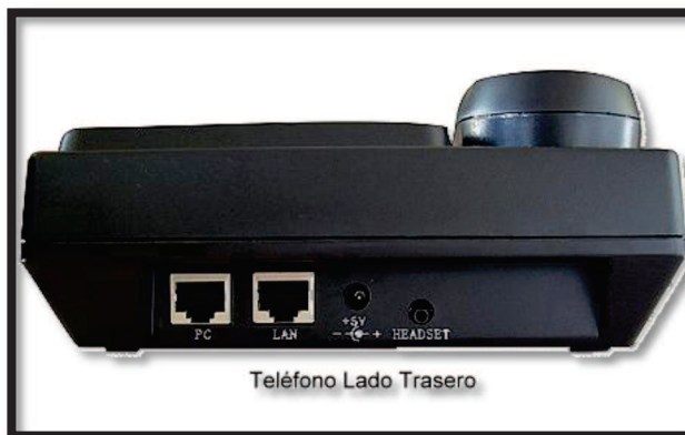
Figura 3.34 Puertos de conexión Ethernet en un teléfono IP [B63]
