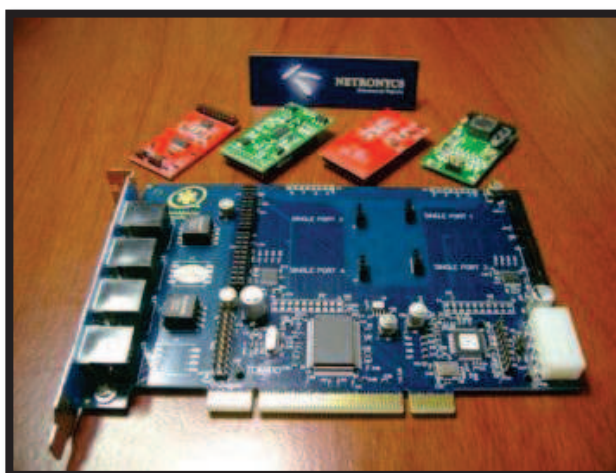
Figura 3.35 Tarjeta PCI de 4 puertos con módulos FXO [B67]
