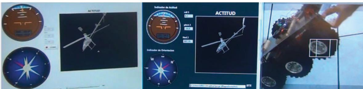
Figura 5.20 Comparación de respuesta de la IMU para un ángulo pitch (de derecha a izquierda: IMU comercial, IMU desarrollada, Plataforma móvil)
