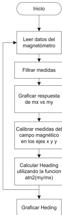
Figura 3.8 Proceso para calcular la orientación
