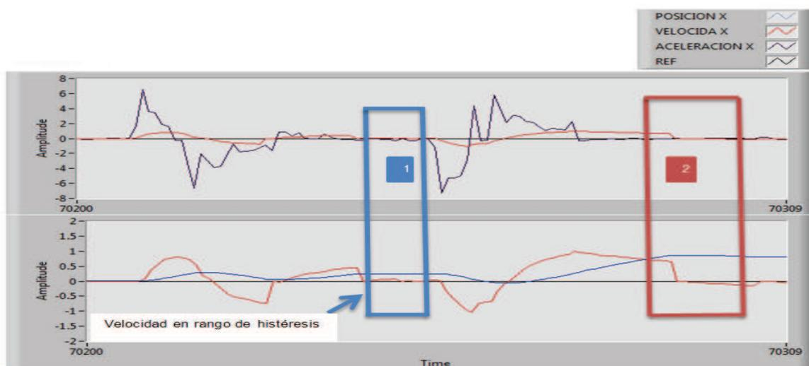
Figura 5.17 Velocidad y posición obtenidas por integración de la aceleración con filtro pasa alto y lazo de histéresis en la salida de velocidad
