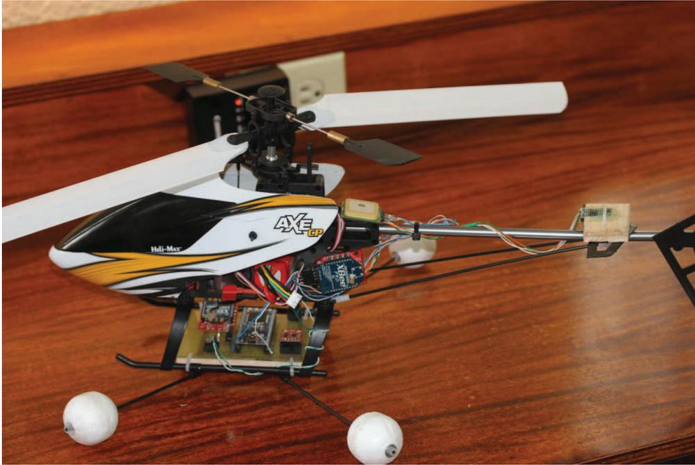
Figura 2.17 INS instalado de un UAV
