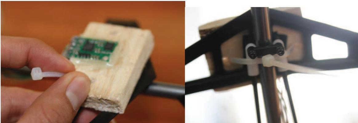
Figura 2.14 Ubicación del magnetómetro en el helicóptero
