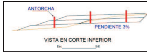
Figura 4.4 Diseño en corte del Cubeto 1 con las antorchas instaladas
