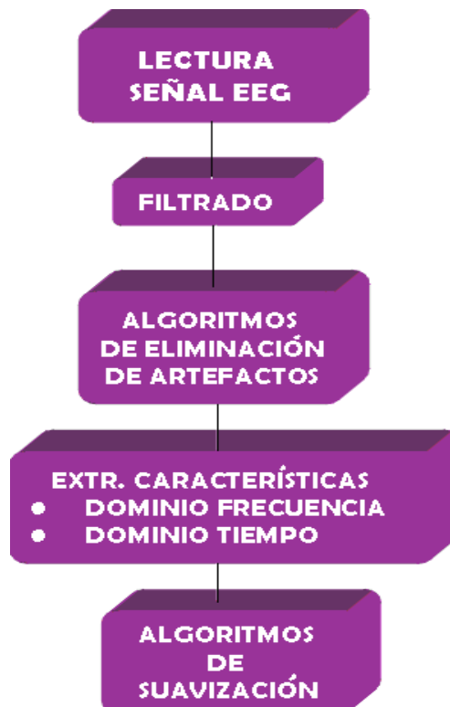
Figura 2.41. Diagrama de bloques general del algoritmo de procesamiento del EEG.
