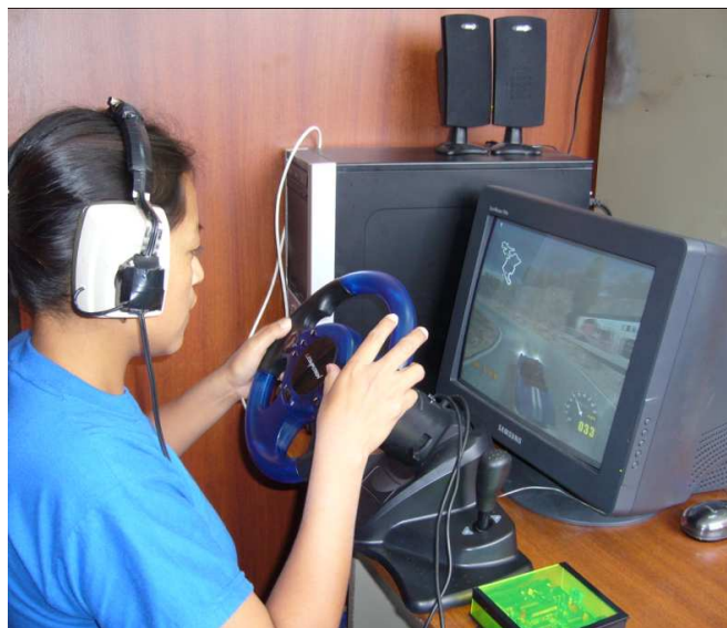
Figura 2.2. Prototipo para monitorización de estado de alerta
