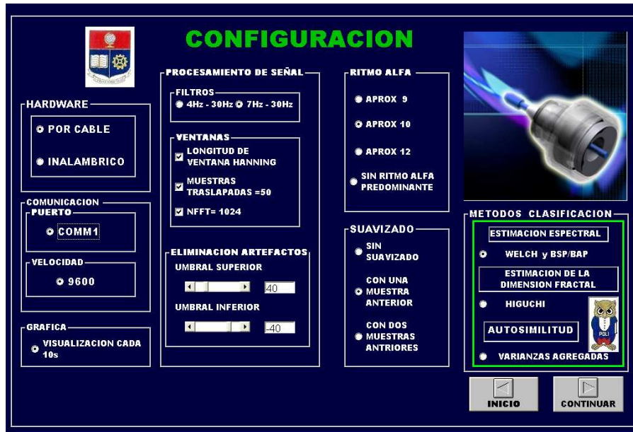
Figura 3.6. Interfaz gráfica en la cual se señala los diferentes métodos de clasificación para tratar a la señal.
